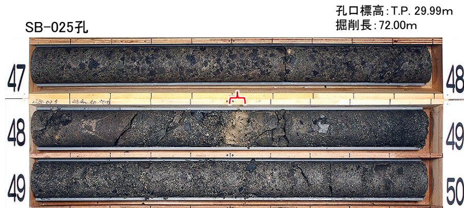
図5.18 SB-025孔コア写真
