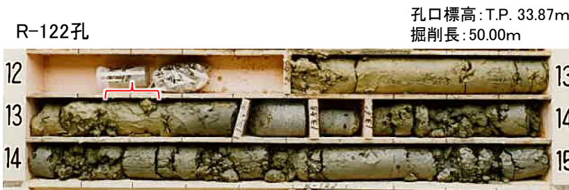
図5.21 R-122孔コア写真 注2) R-122孔の孔径は66mmであり、他のボーリング孔の孔径(116mm)に比べて小さい。
