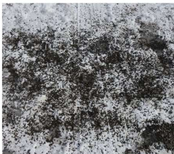
第3図 すべり止め材の散布例
