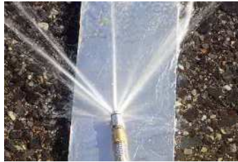
第3～6管支持板用(噴射ノズルを改良)
