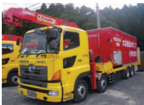
大容量送水ポンプ（タイプ I）
