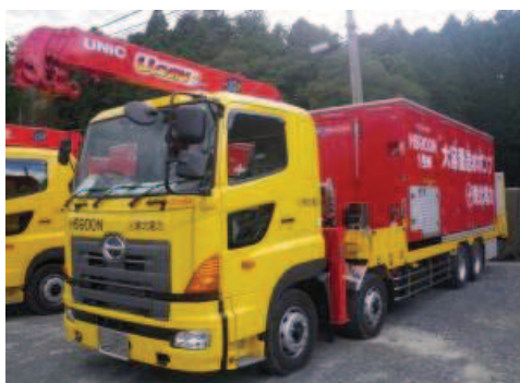
大容量送水ポンプ（タイプ I）
