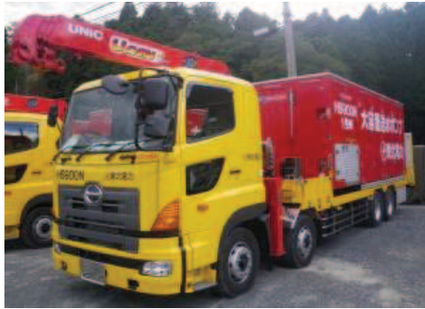
大容量送水ポンプ (タイプ I)
