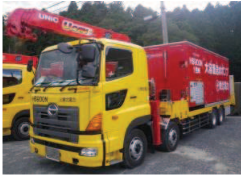
大容量送水ポンプ (タイプ I)
