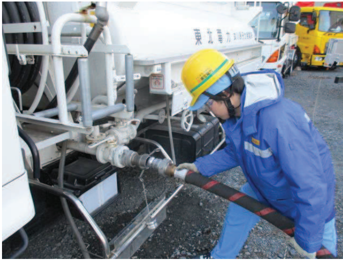
タンクローリへのホース接続
