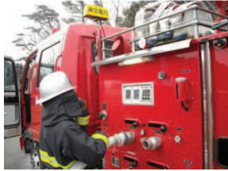
化学消防自動車へのホース接続
