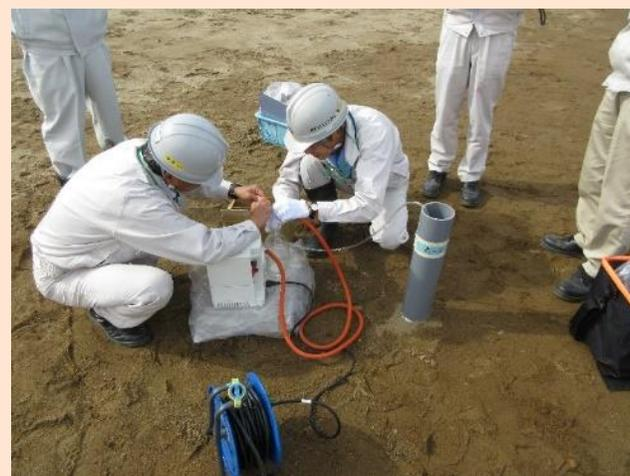
除去土壌の埋立てを行うとともに、環境放射線量の変化や浸透水への核種移行の測定等を実施
