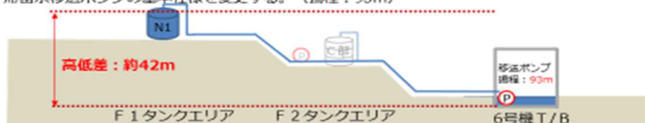
図1 5・6号機滞留水移送設備概略図
