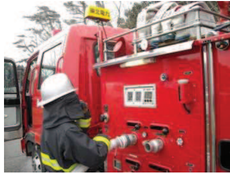
化学消防自動車へのホース接続
