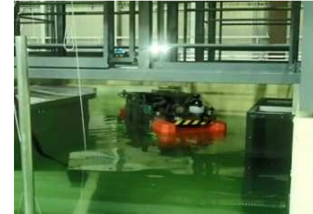
ROV航走試験 (狭隘部通過)
