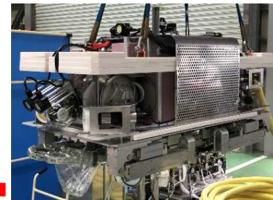
容器封入作業用ROV
