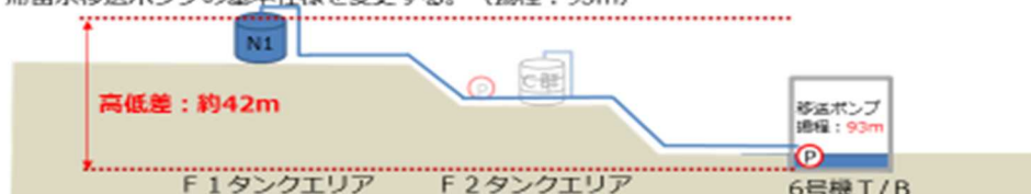
図1 5・6号機滞留水移送設備概略図
