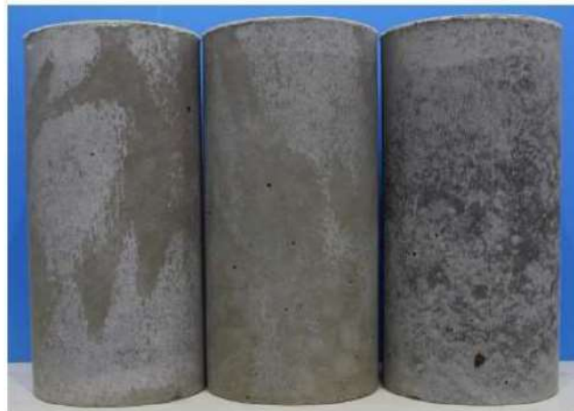
第 7-51 図 セメント改良土の室内試験用供試体 ( \phi 150\text{mm} , H300mm)
