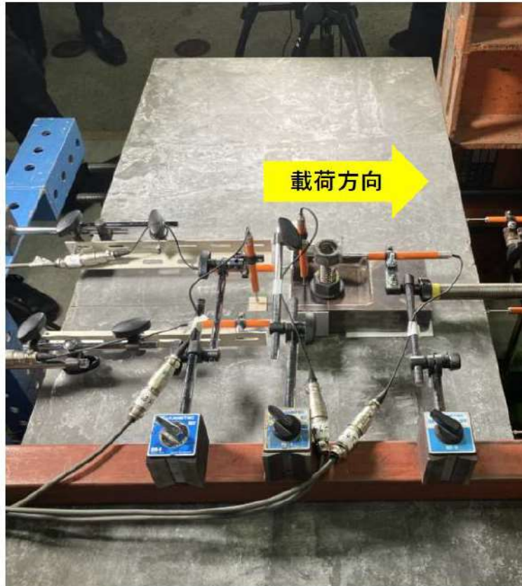
第 7-71 図 せん断試験最大荷重载荷後の状況写真（破壊形式確認ケース）
