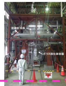
モックアップ試験棟内の3号溶融炉設置状況
