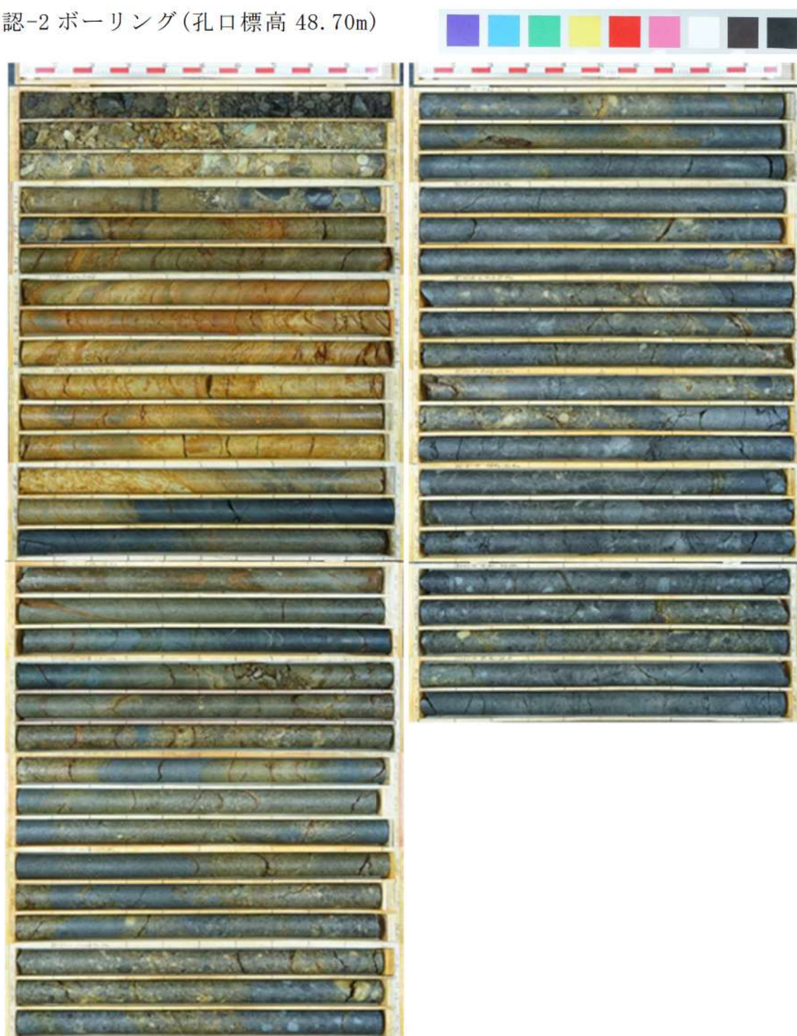
図 2.1.a.c-4 (23) 防潮堤(茶津側) ボーリングコア写真 確認-2 ボーリング (L=50m)
