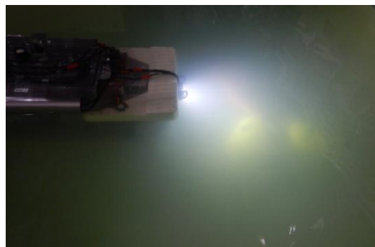
ゼオライト回収作業後（濁度上昇）
