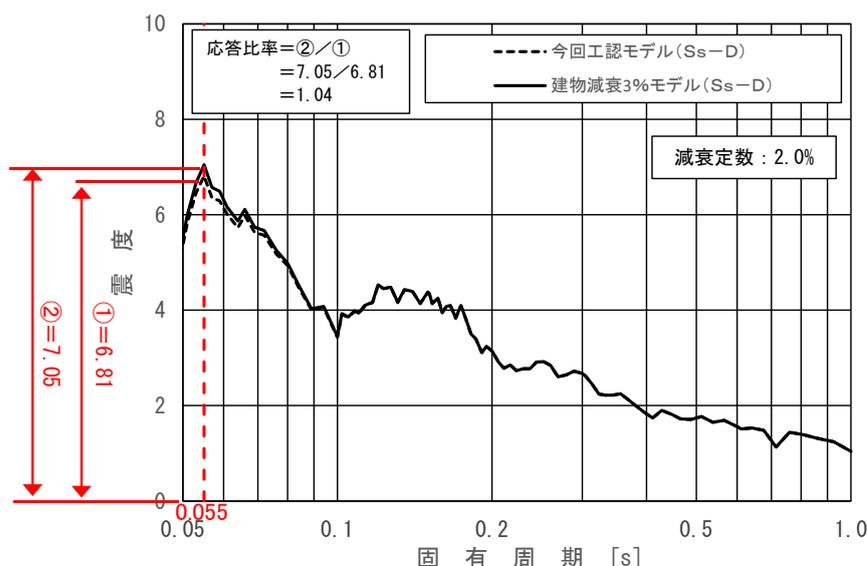
図2-1 床応答スペクトルにおける応答比率の算定例
