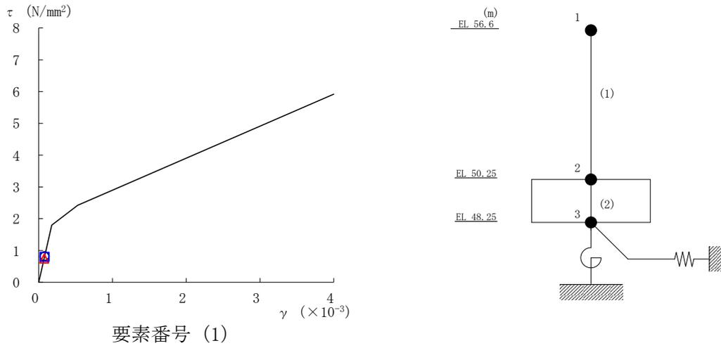
図 4-37 せん断スケルトン曲線上の最大応答値（基準地震動 S<sub>s</sub>-D, NS 方向）
