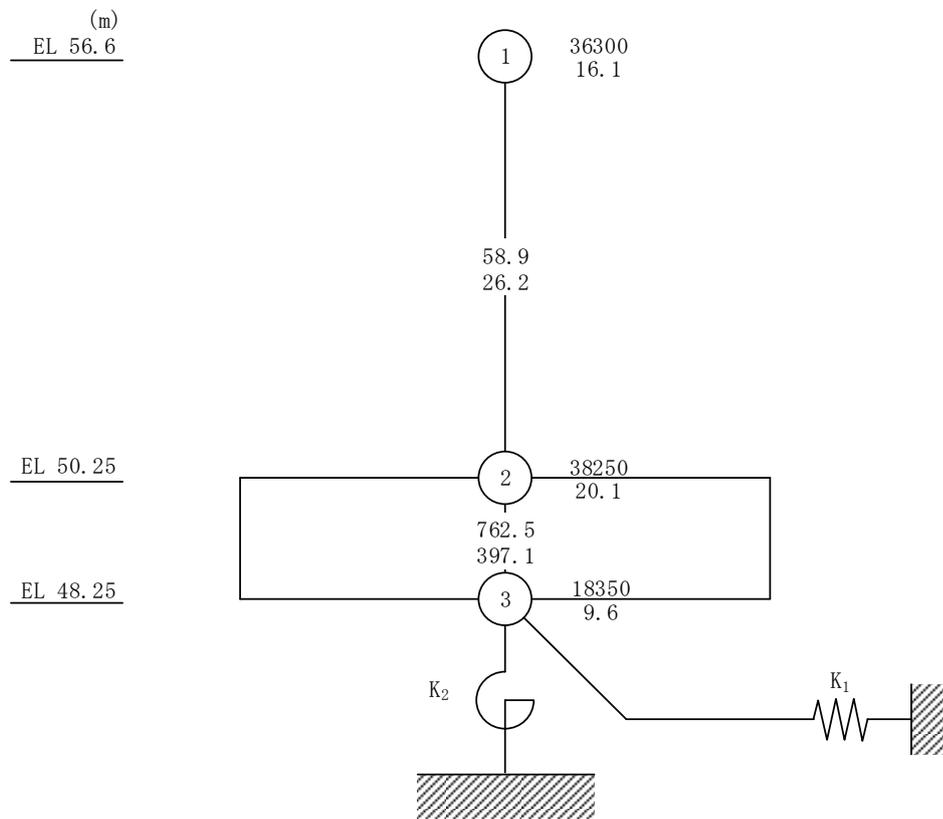
図 3-1(2) 地震応答解析モデル (EW方向)
