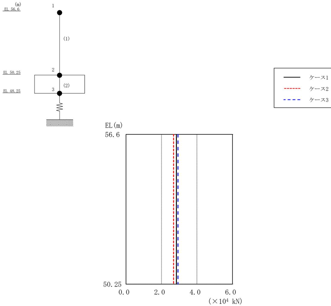
図 2-11 最大応答軸力（基準地震動 S<sub>s</sub>-D，鉛直方向）
