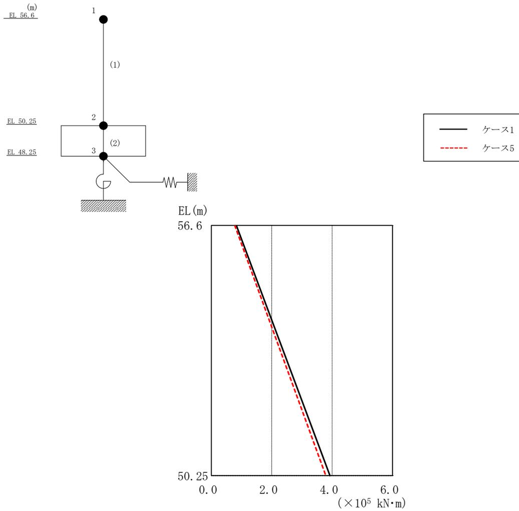
図 4-10 最大応答曲げモーメント (基準地震動 S<sub>s</sub>-D, NS 方向)
