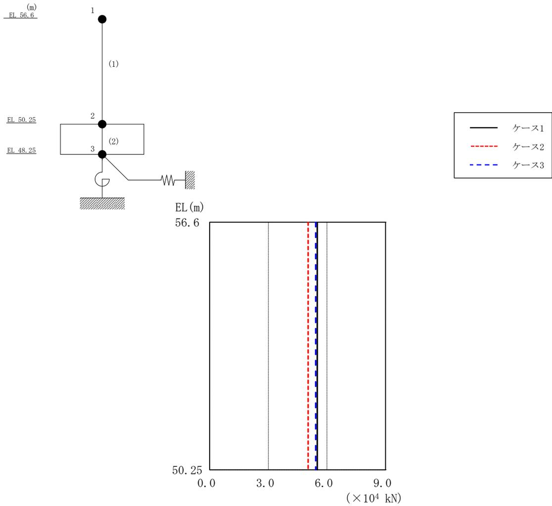
図 4-28 最大応答せん断力（基準地震動 S<sub>s</sub>-D, NS 方向）
