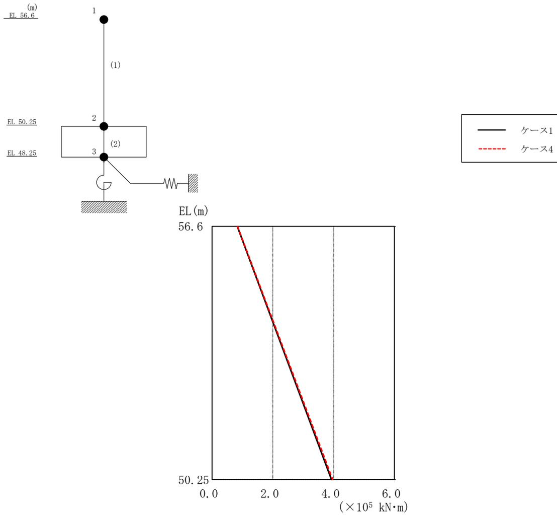
図 4-45 最大応答曲げモーメント (基準地震動 S<sub>s</sub>-D, NS 方向)
