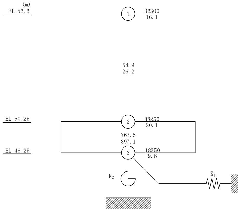
図 4-3(2) 緊急時対策所の地震応答解析モデル (ケース 5) (EW方向)
