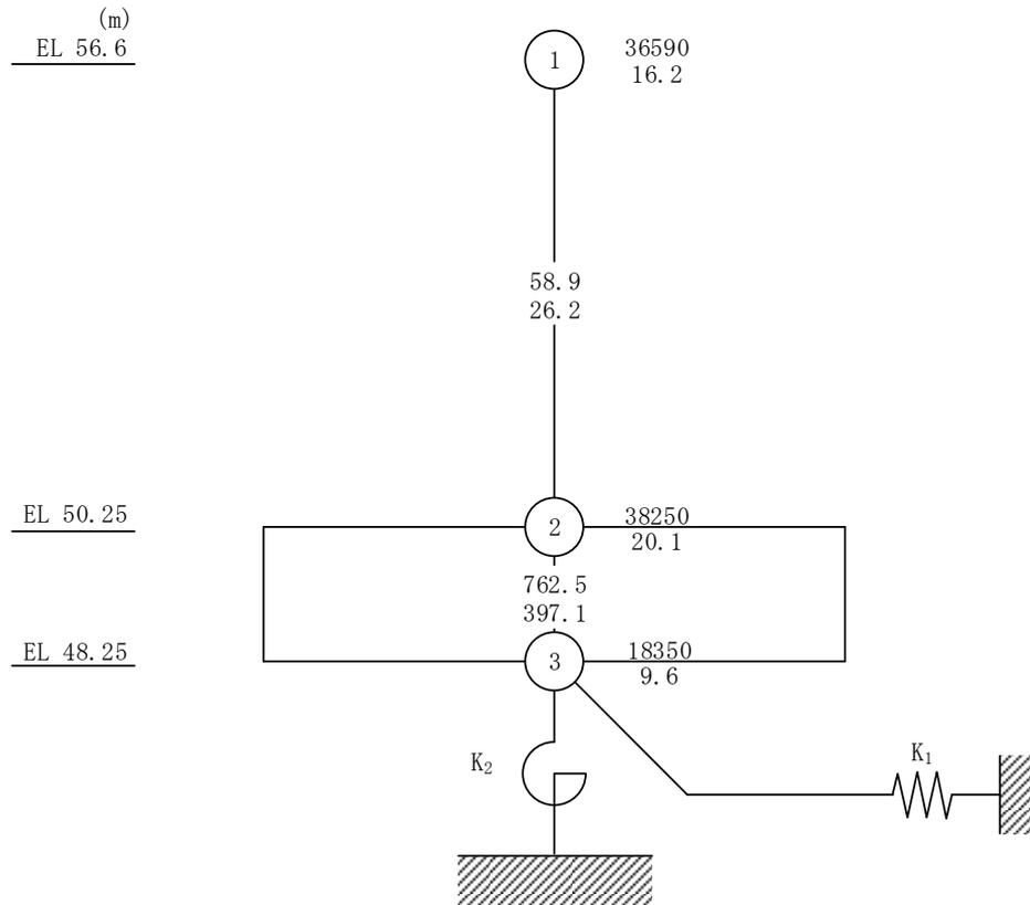
図 4-2(2) 緊急時対策所の地震応答解析モデル (ケース 4) (EW方向)
