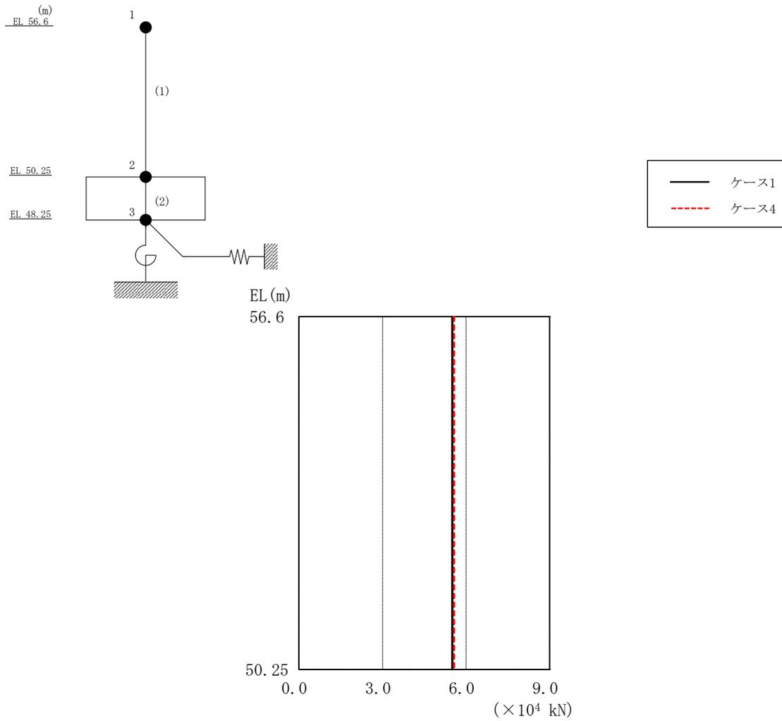
図 4-44 最大応答せん断力（基準地震動 S<sub>s</sub>-D, NS 方向）
