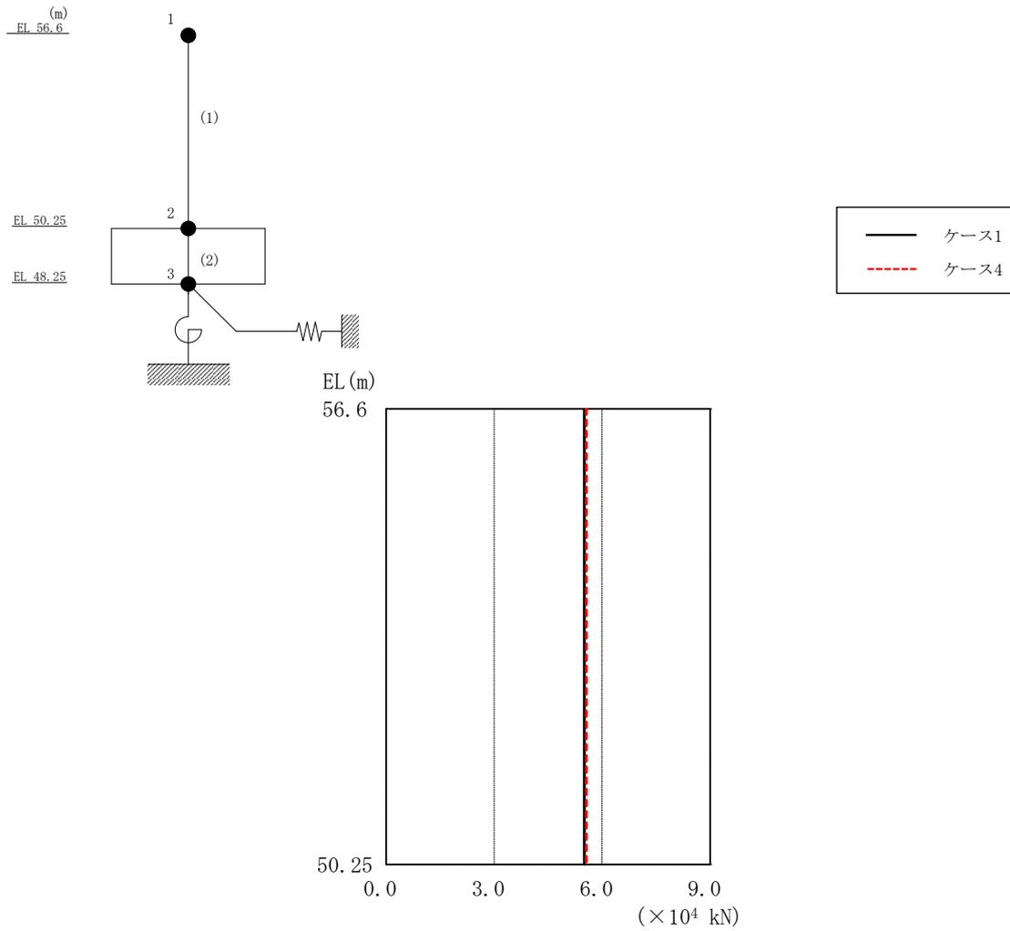
図 2-16 最大応答せん断力（基準地震動 S<sub>s</sub>-D, NS 方向）
