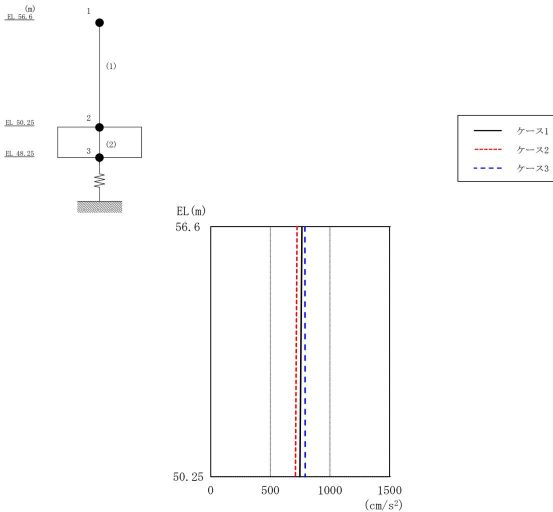
図 2-9 最大応答加速度 (基準地震動 S<sub>s</sub>-D, 鉛直方向)
