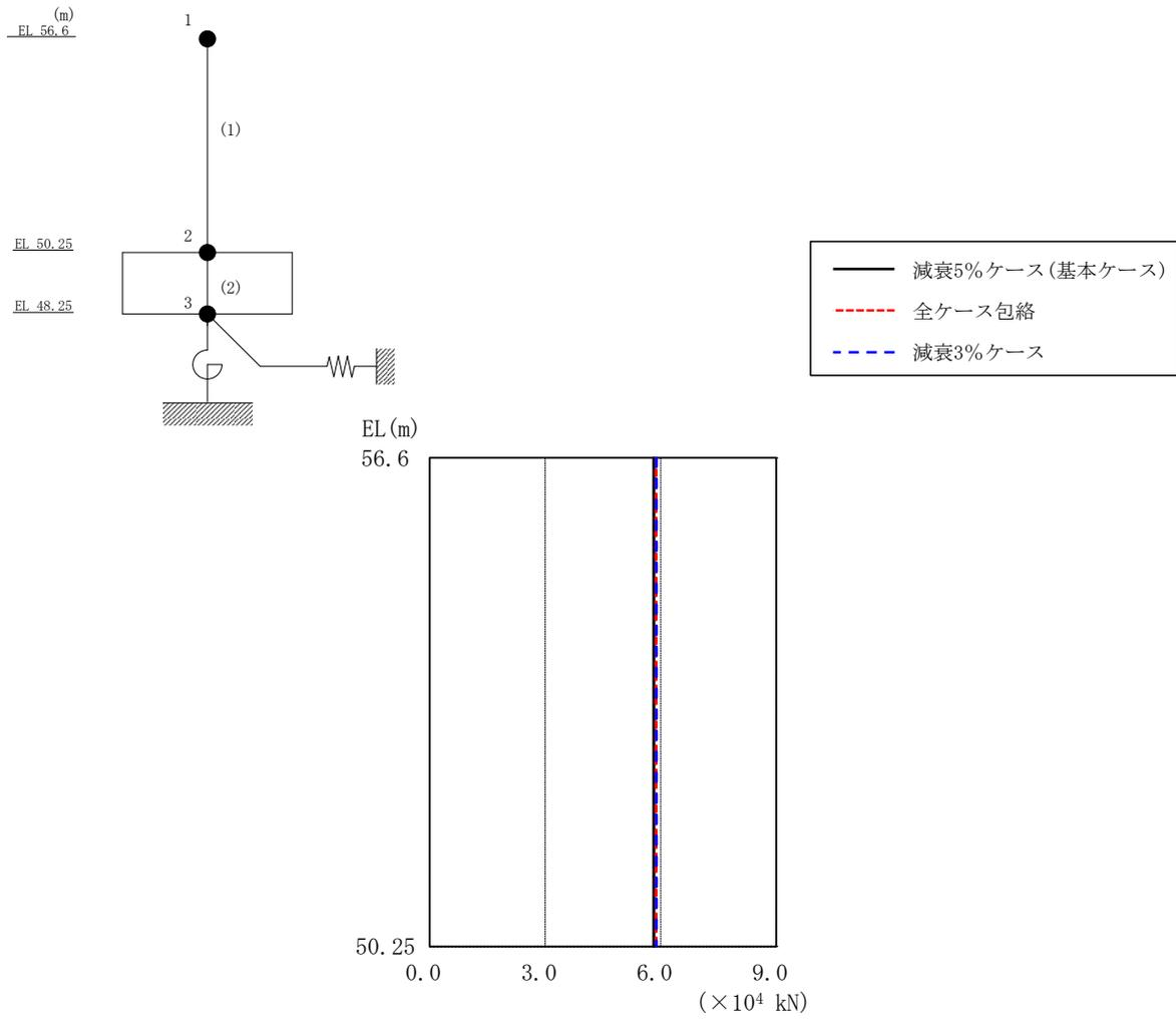
図 3-7 最大応答せん断力 (基準地震動 S<sub>s</sub>-D, EW方向)
