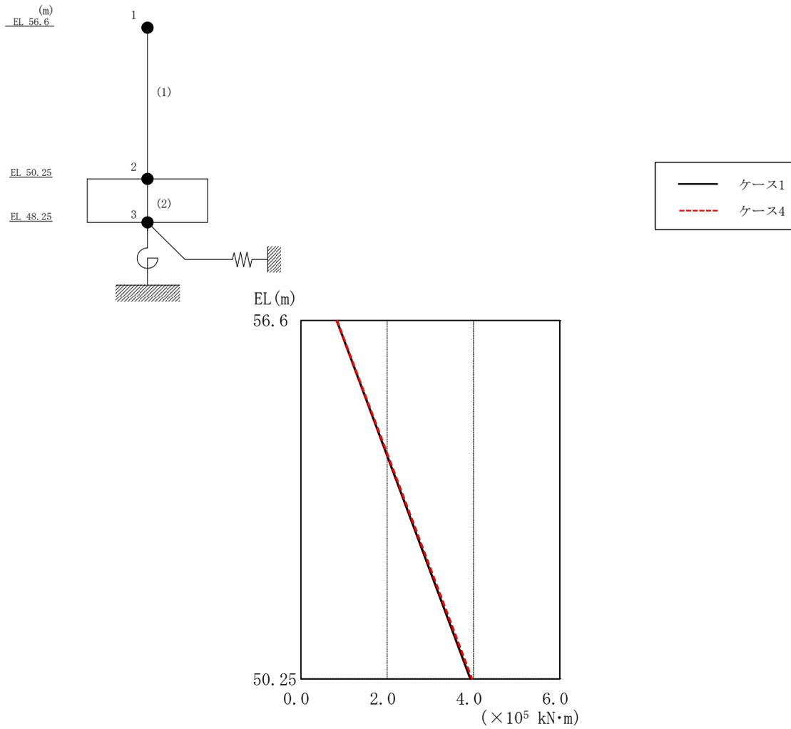
図 2-17 最大応答曲げモーメント (基準地震動 S<sub>s</sub>-D, NS 方向)
