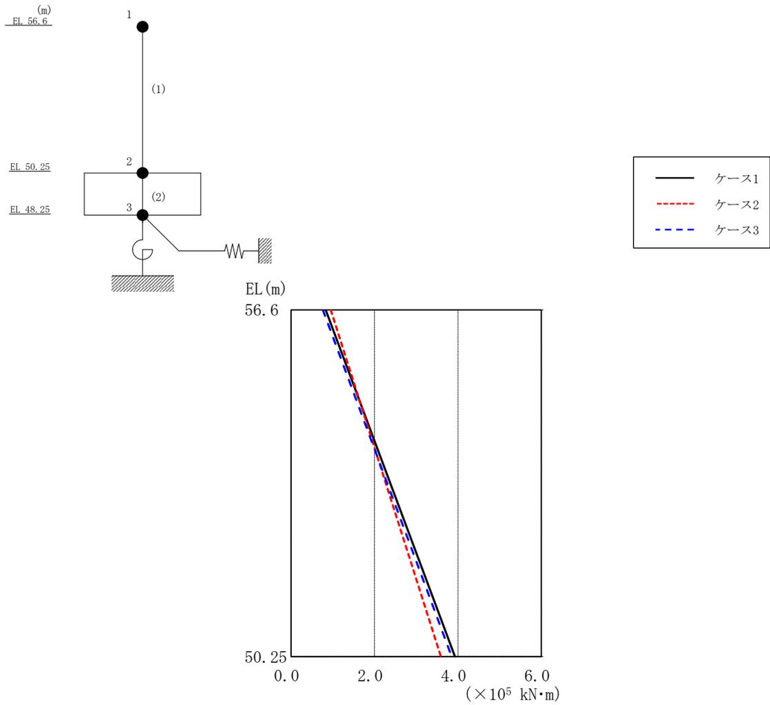
図 4-29 最大応答曲げモーメント (基準地震動 S<sub>s</sub>-D, NS 方向)
