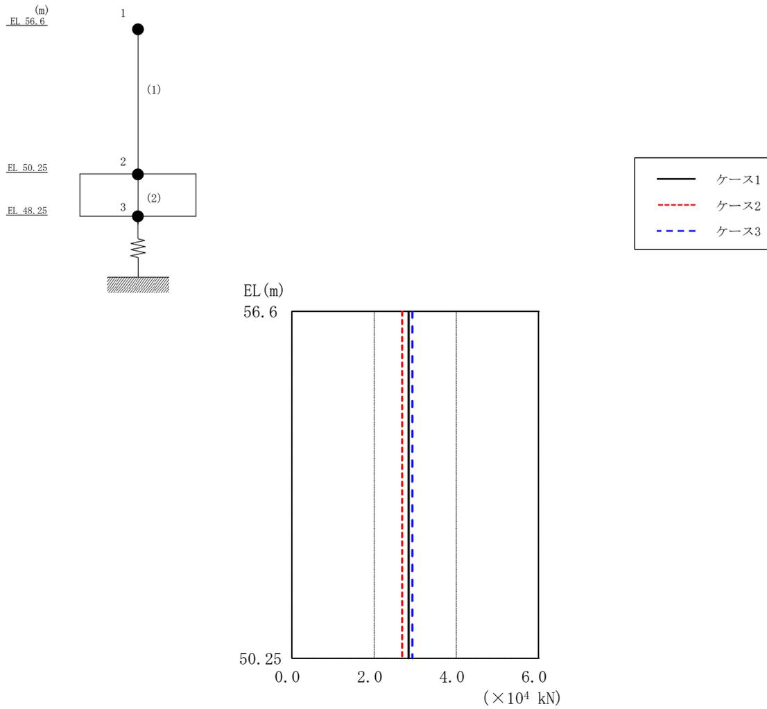
図 4-36 最大応答軸力（基準地震動 S<sub>s</sub>-D，鉛直方向）
