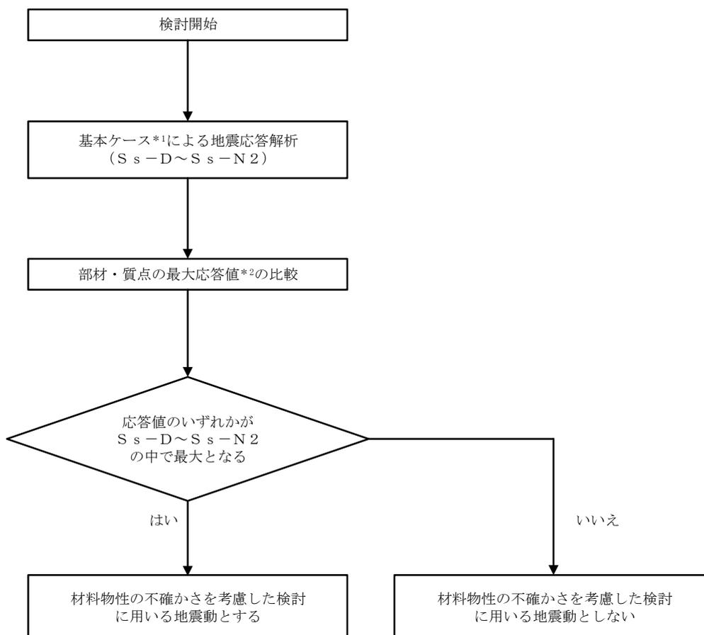
注記\*1：コンクリート強度：設計基準強度，地盤物性：標準地盤
