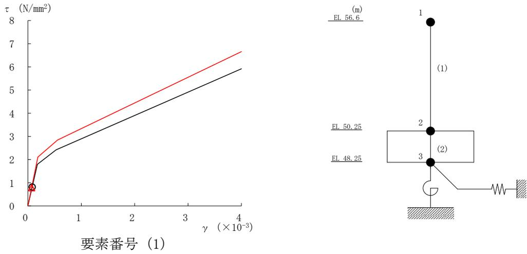
図 4-18 せん断スケルトン曲線上の最大応答値（基準地震動 S<sub>s</sub>-D, NS 方向）
