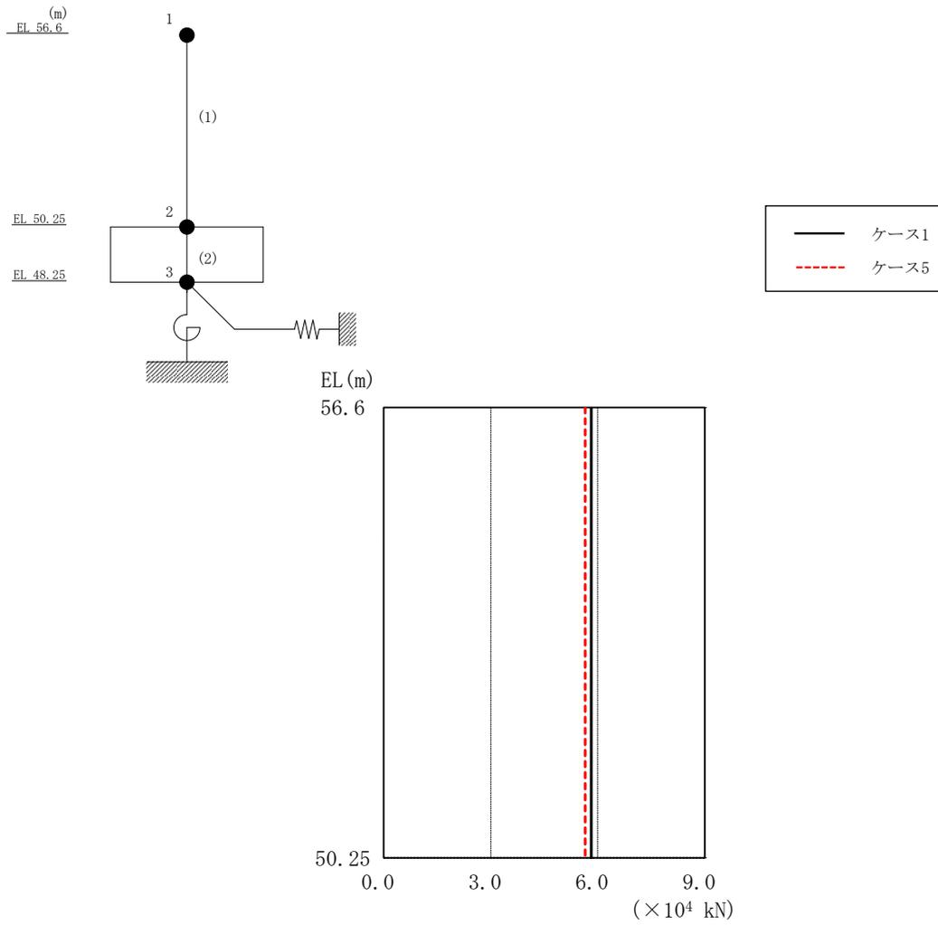
図 4-13 最大応答せん断力（基準地震動 S<sub>s</sub>-D，EW 方向）
