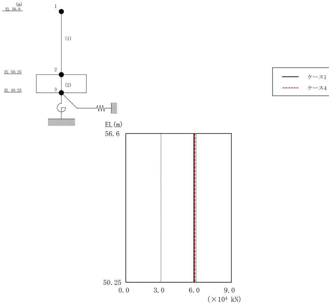
図 2-20 最大応答せん断力 (基準地震動  $S_s - D$ , EW方向)
