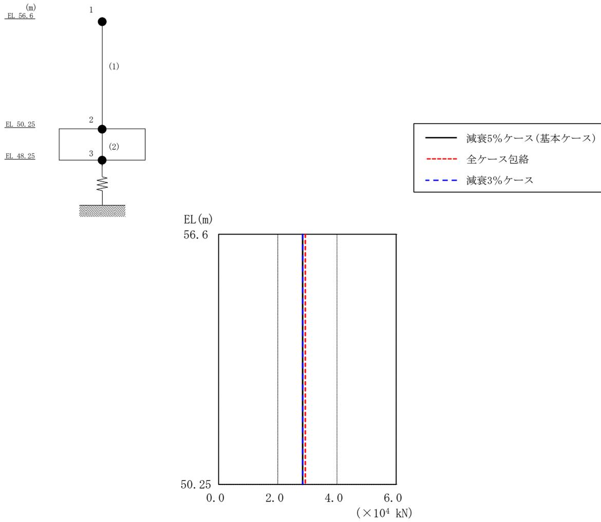
図 3-11 最大応答軸力（基準地震動 S<sub>s</sub>-D，鉛直方向）
