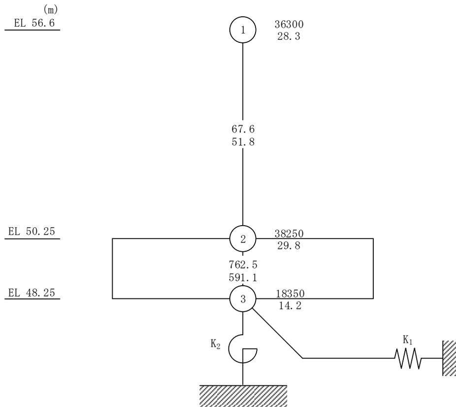
図 4-3(1) 緊急時対策所の地震応答解析モデル (ケース 5) (NS 方向)
