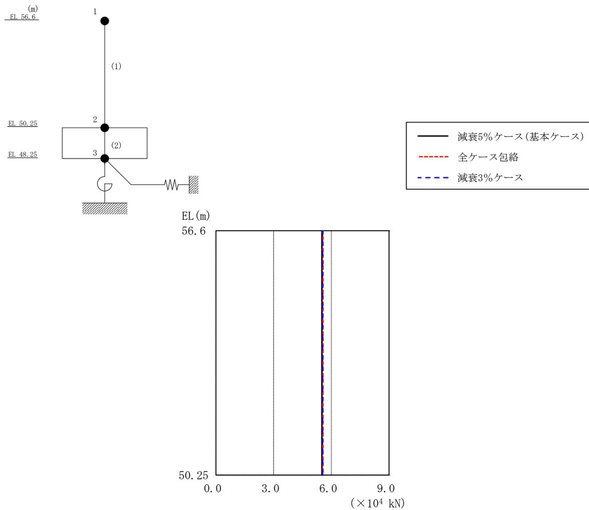
図 3-3 最大応答せん断力 (基準地震動 S<sub>s</sub>-D, NS 方向)
