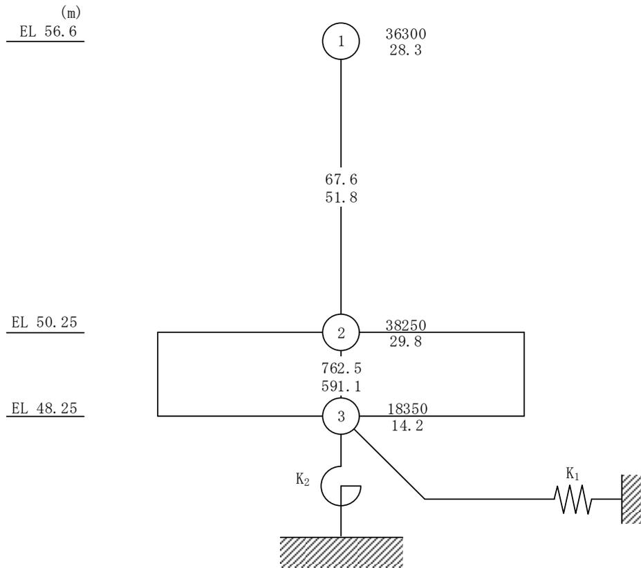
図 3-1(1) 地震応答解析モデル (N S 方向)
