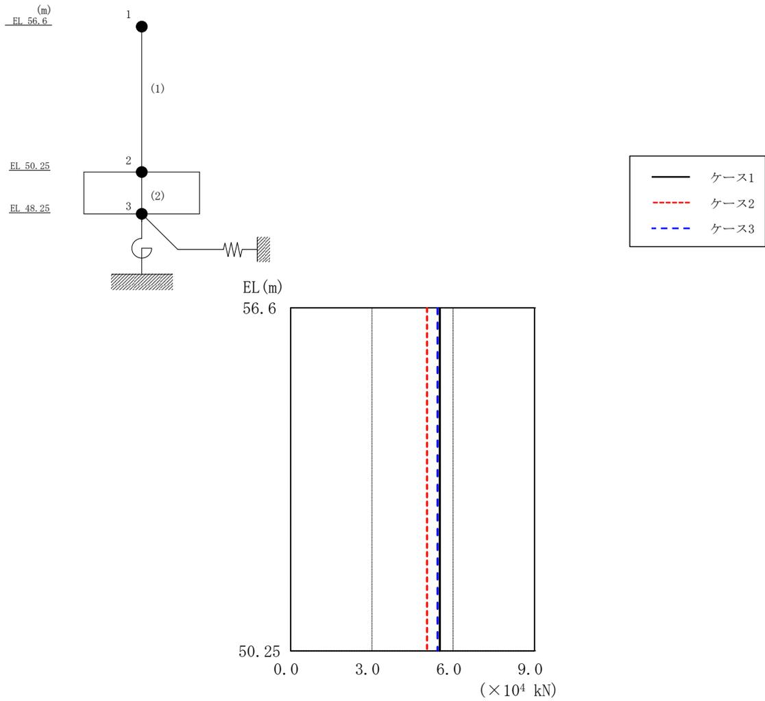
図 2-3 最大応答せん断力 (基準地震動 S<sub>s</sub>-D, NS 方向)
