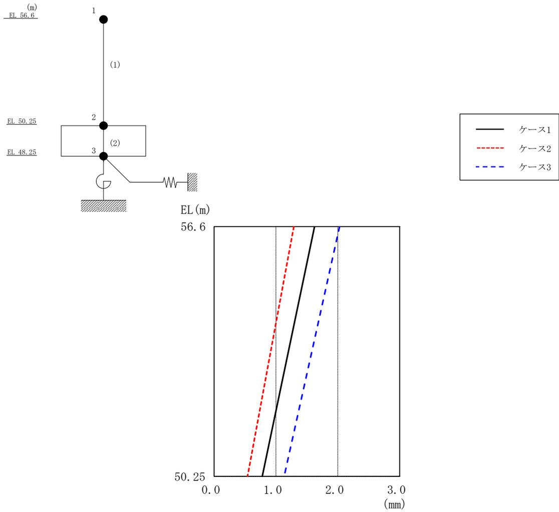
図 4-31 最大応答変位 (基準地震動 S<sub>s</sub>-D, EW方向)
