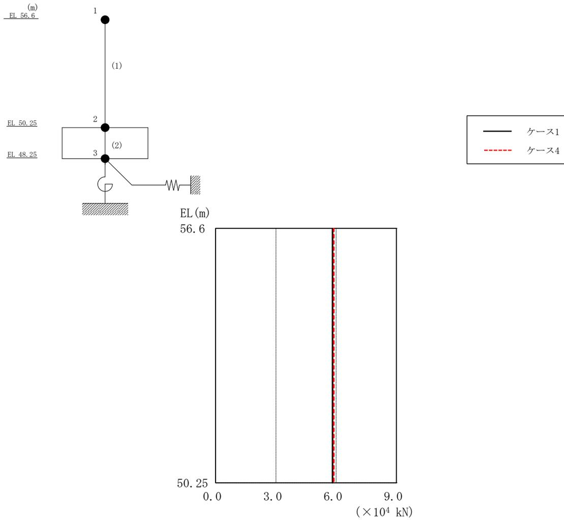
図 4-48 最大応答せん断力（基準地震動  $S_s - D$ ，EW方向）
