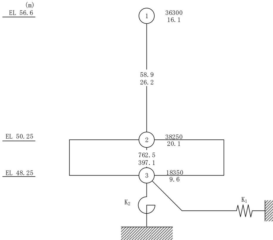
図 4-1 (2) 緊急時対策所の地震応答解析モデル (ケース 1~ケース 3) (E W方向)
