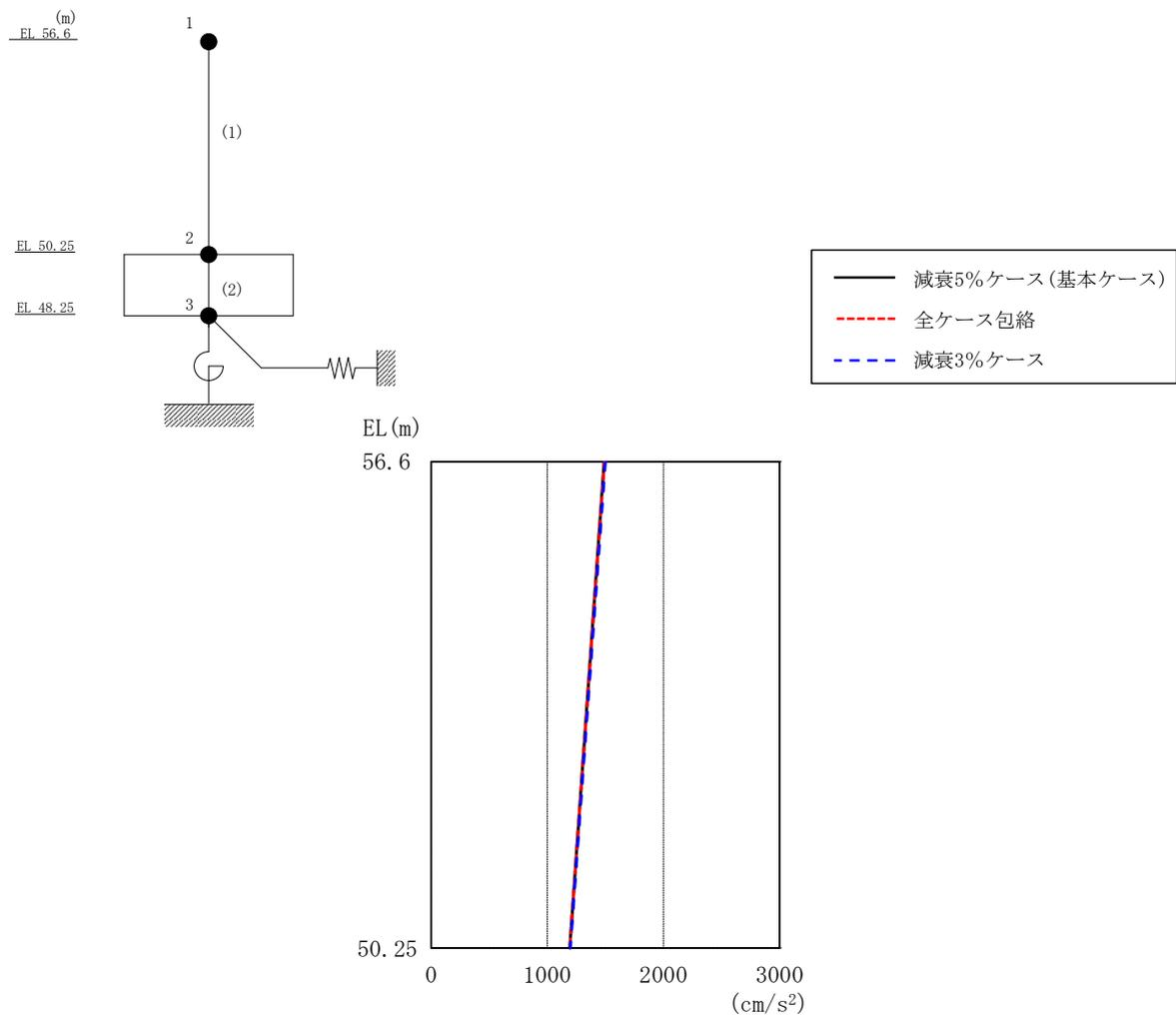
図 3-1 最大応答加速度 (基準地震動 S<sub>s</sub>-D, NS 方向)
