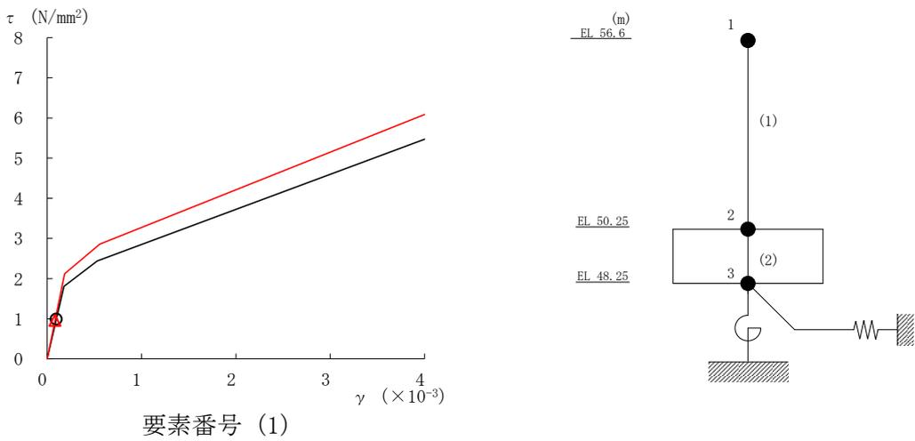
図 4-19 せん断スケルトン曲線上の最大応答値（基準地震動 S<sub>s</sub>-D, EW 方向）
