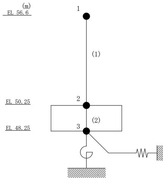
図 2-1 (2) 地震応答解析モデル (E W 方向)
