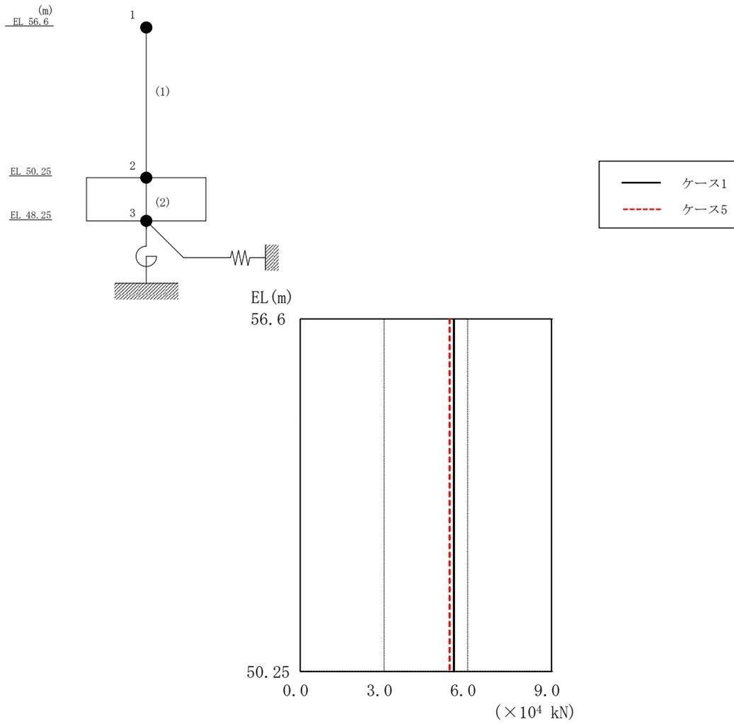
図 4-9 最大応答せん断力 (基準地震動 S<sub>s</sub>-D, NS 方向)
