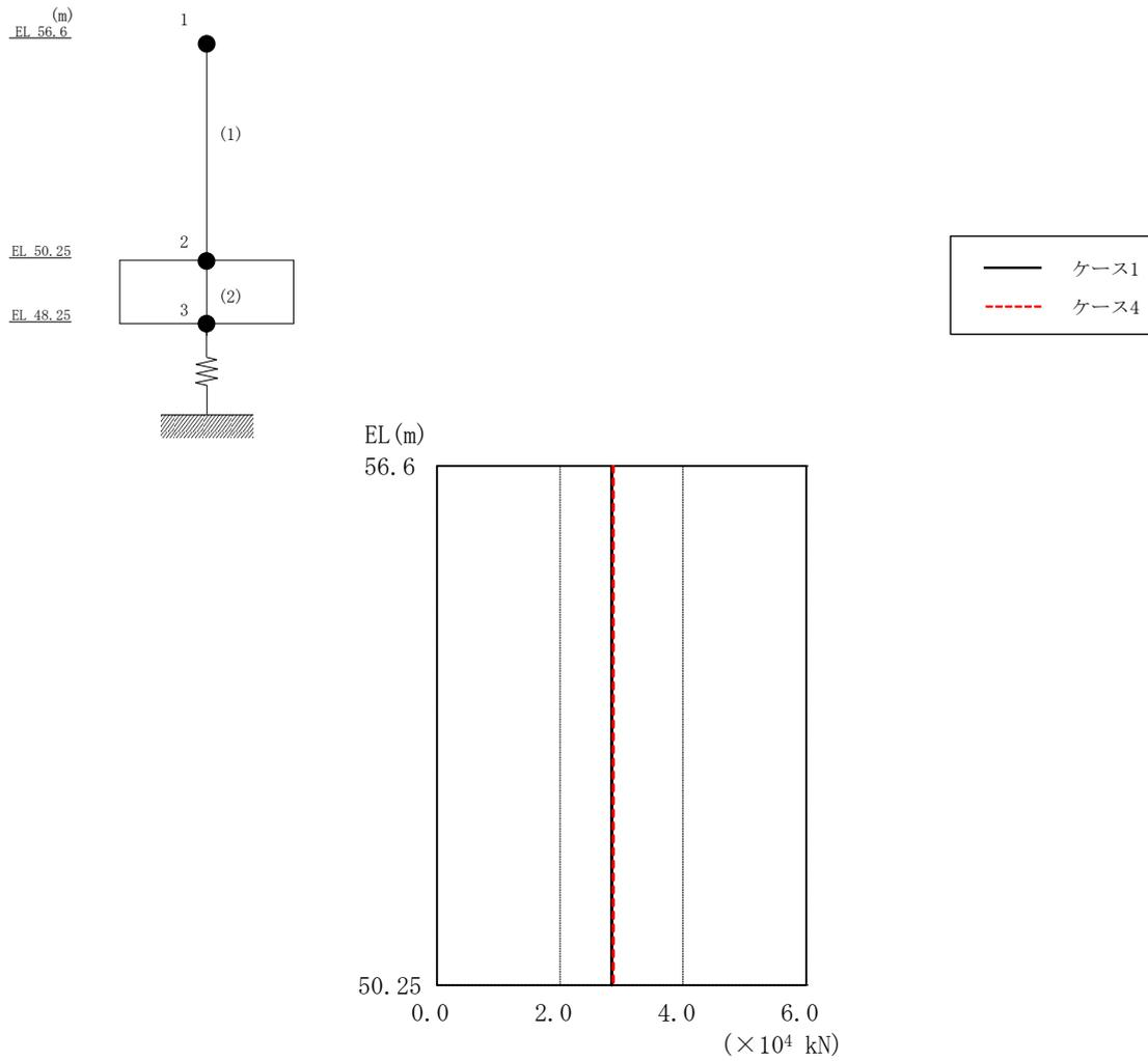
図 2-24 最大応答軸力（基準地震動 S s - D，鉛直方向）
