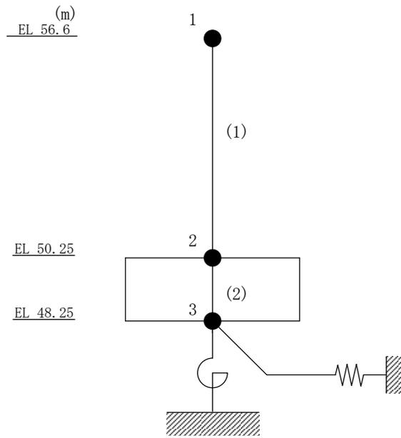
図 2-1 (1) 地震応答解析モデル (N S 方向)
