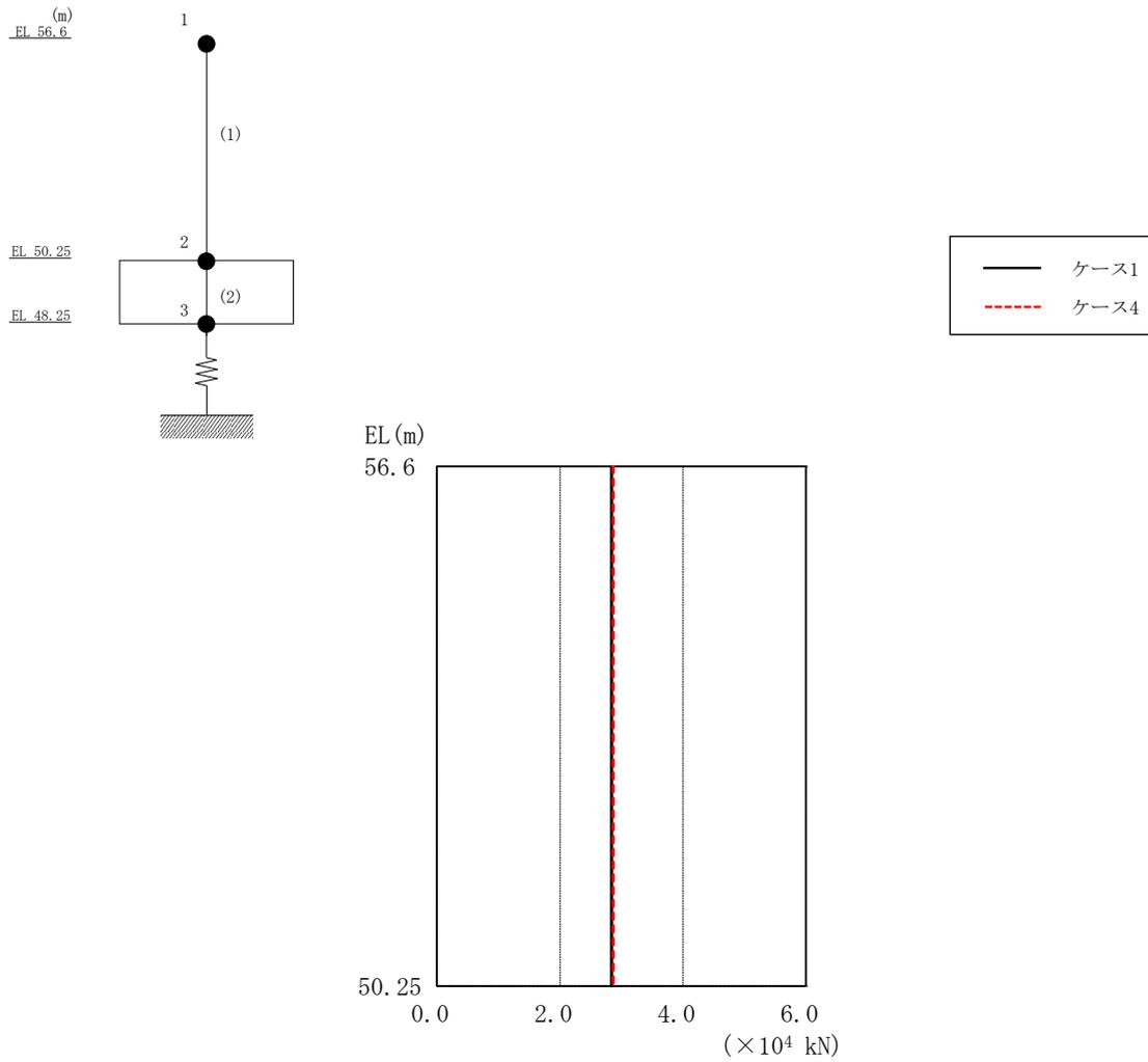
図 4-52 最大応答軸力（基準地震動 S s - D，鉛直方向）
