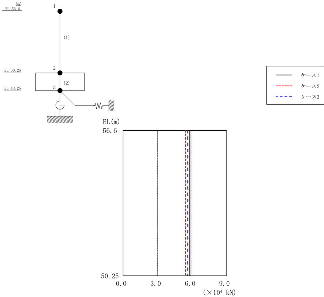
図 4-32 最大応答せん断力（基準地震動 S<sub>s</sub>-D，EW方向）
