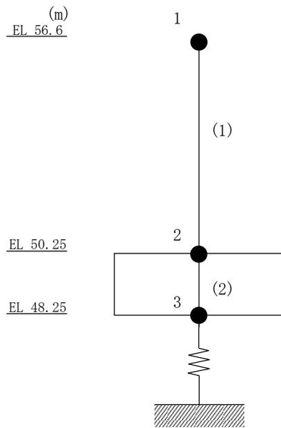
図 2-2 地震応答解析モデル (鉛直方向)
