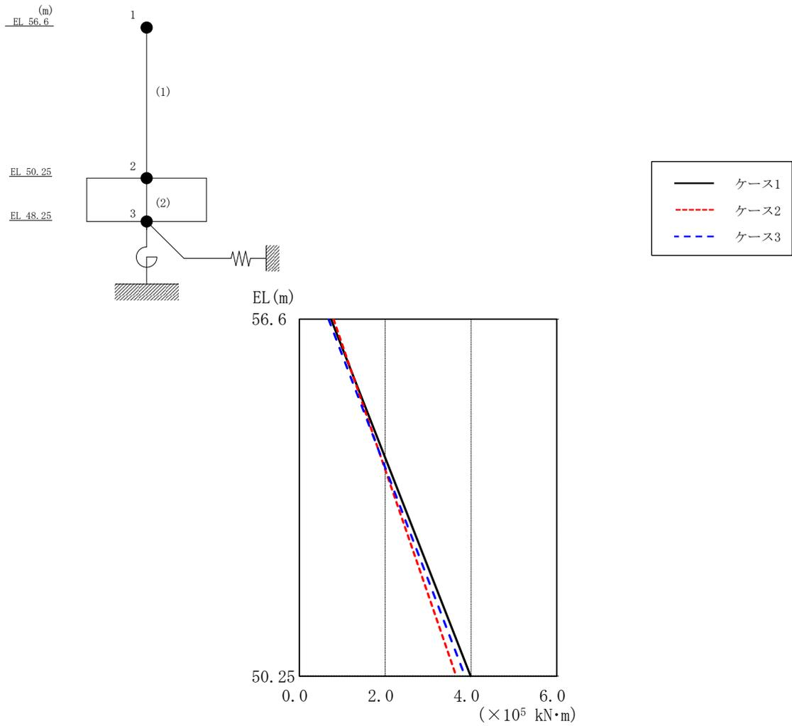
図 4-33 最大応答曲げモーメント (基準地震動 S<sub>s</sub>-D, EW方向)
