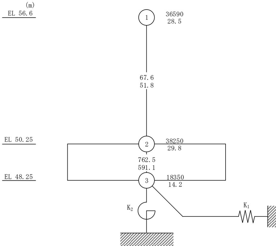
図 4-2(1) 緊急時対策所の地震応答解析モデル (ケース 4) (NS 方向)
