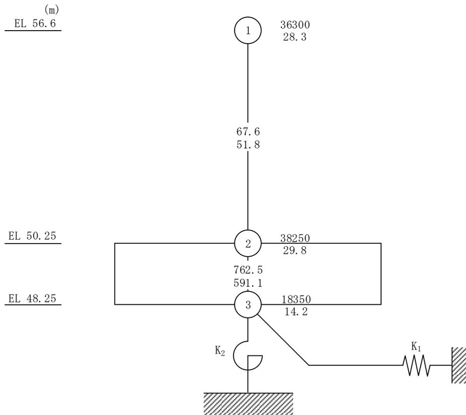
図 4-1 (1) 緊急時対策所の地震応答解析モデル (ケース 1~ケース 3) (N S 方向)
