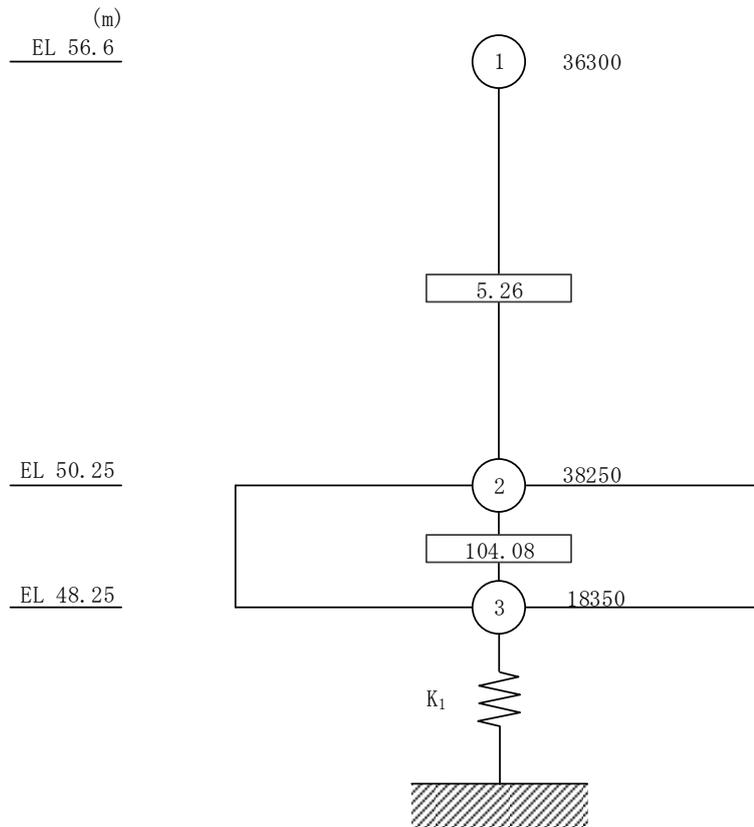
図 4-3(3) 緊急時対策所の地震応答解析モデル (ケース 5) (鉛直方向)
