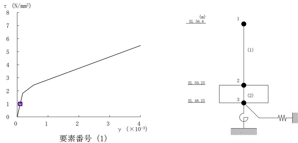
図 3-13 せん断スケルトン曲線上の最大応答値 (基準地震動  $S_s - D$ , EW 方向)
