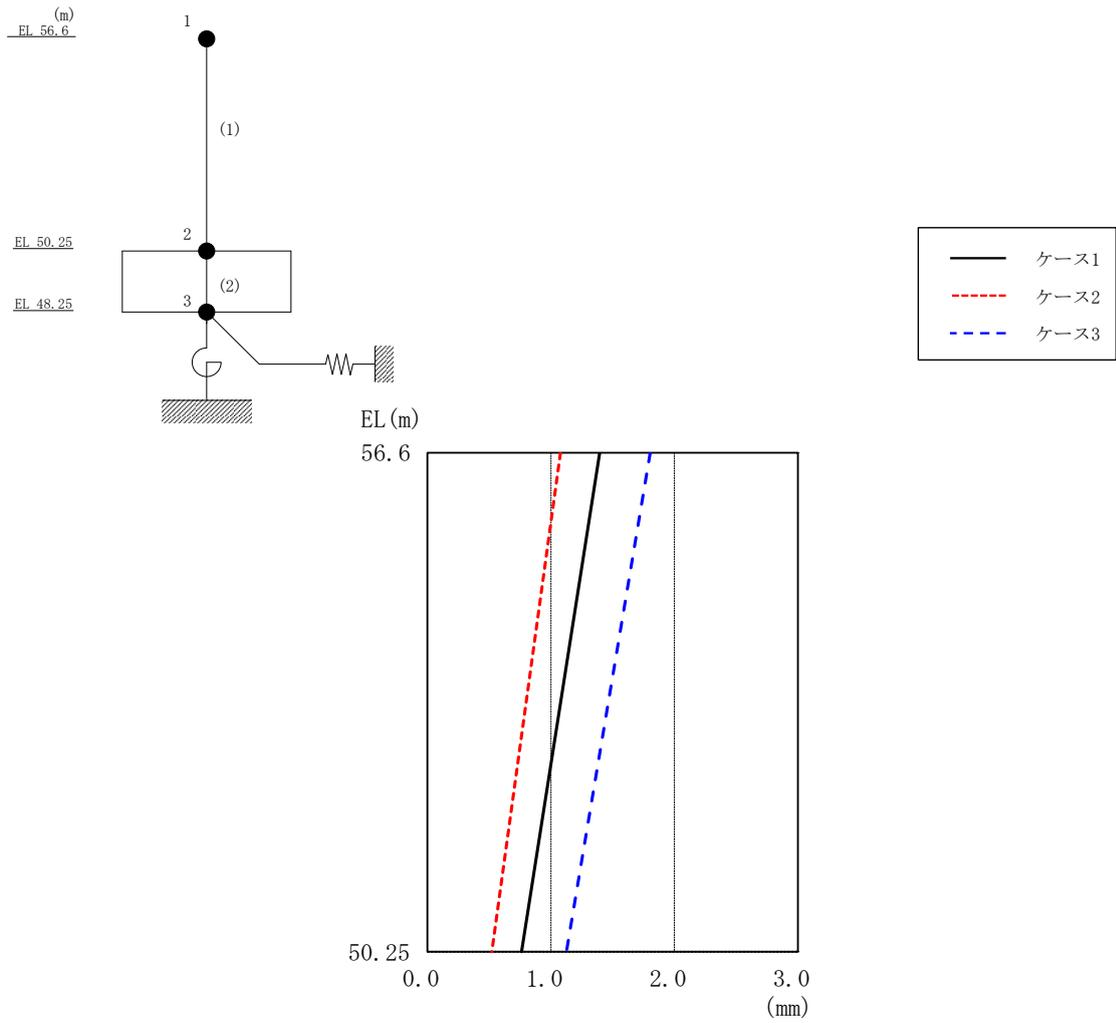
図 4-27 最大応答変位 (基準地震動 S<sub>s</sub>-D, NS 方向)
