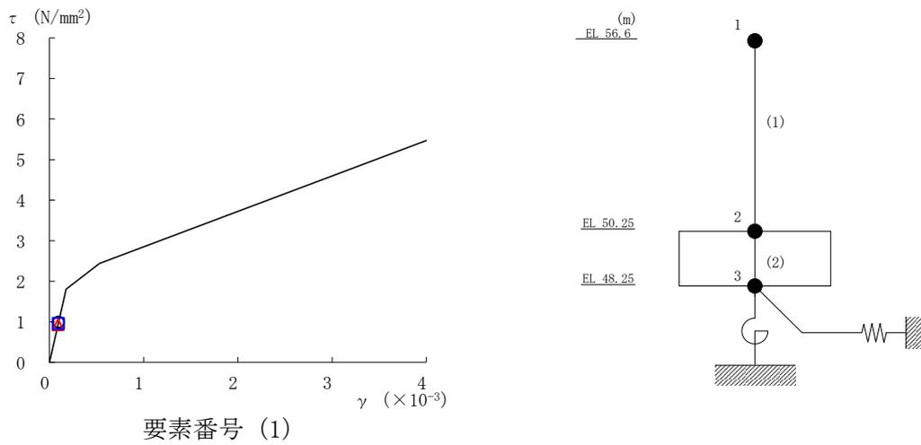
図 4-38 せん断スケルトン曲線上の最大応答値（基準地震動 S<sub>s</sub>-D, EW 方向）
