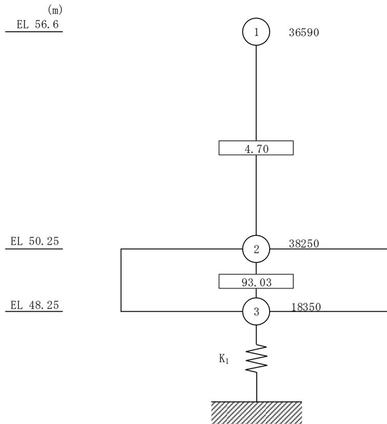
図 4-2(3) 緊急時対策所の地震応答解析モデル (ケース 4) (鉛直方向)
