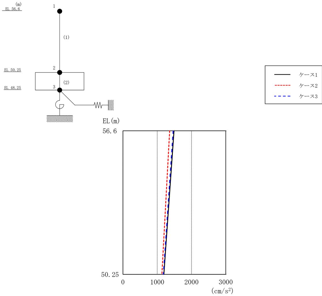
図 2-1 最大応答加速度 (基準地震動 S<sub>s</sub>-D, NS 方向)
