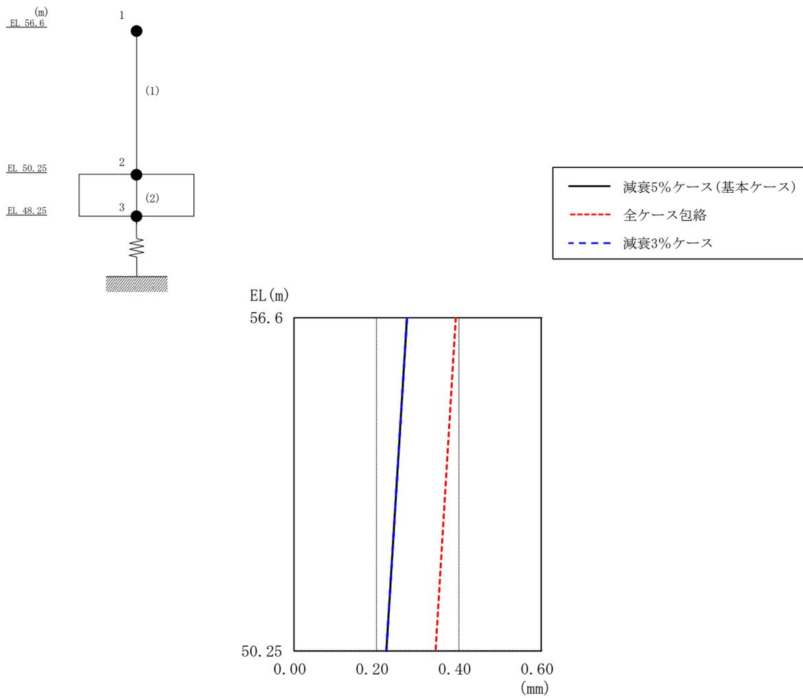
図 3-10 最大応答変位（基準地震動 S<sub>s</sub>-D，鉛直方向）
