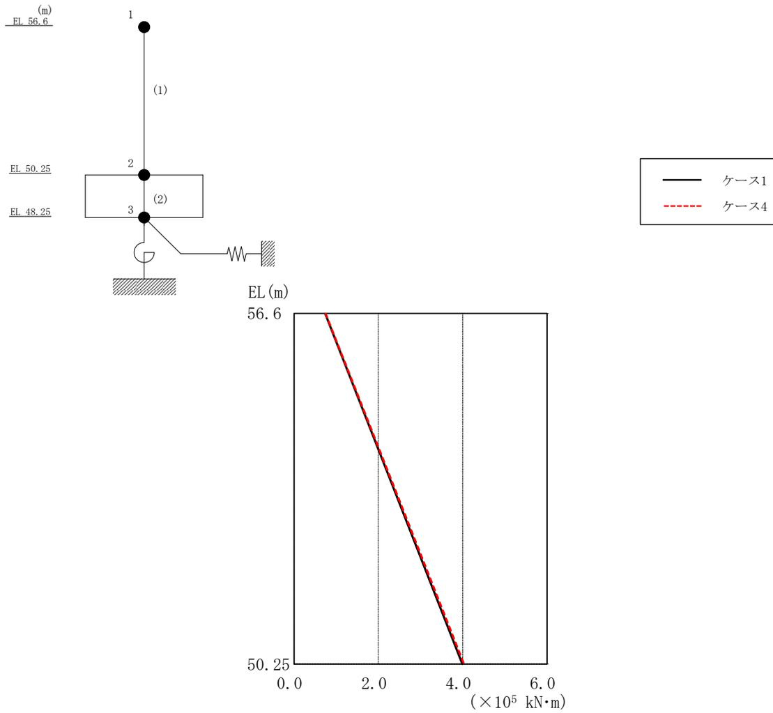
図 2-21 最大応答曲げモーメント (基準地震動 S<sub>s</sub>-D, EW方向)
