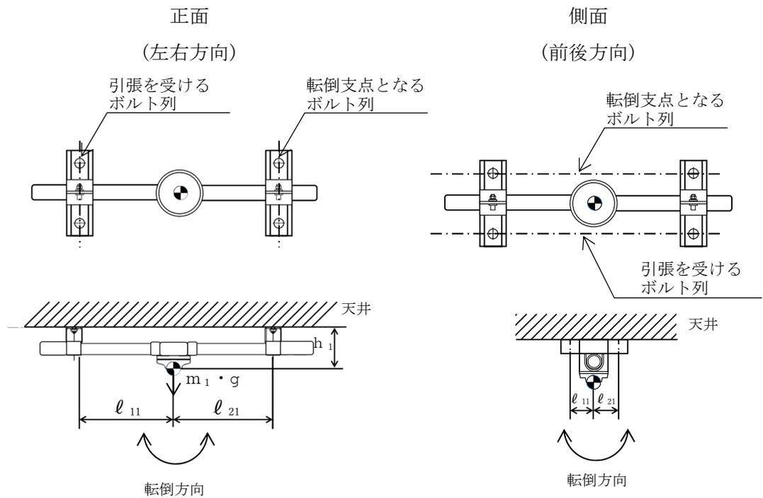
図5-1 火災感知器①の計算モデル
