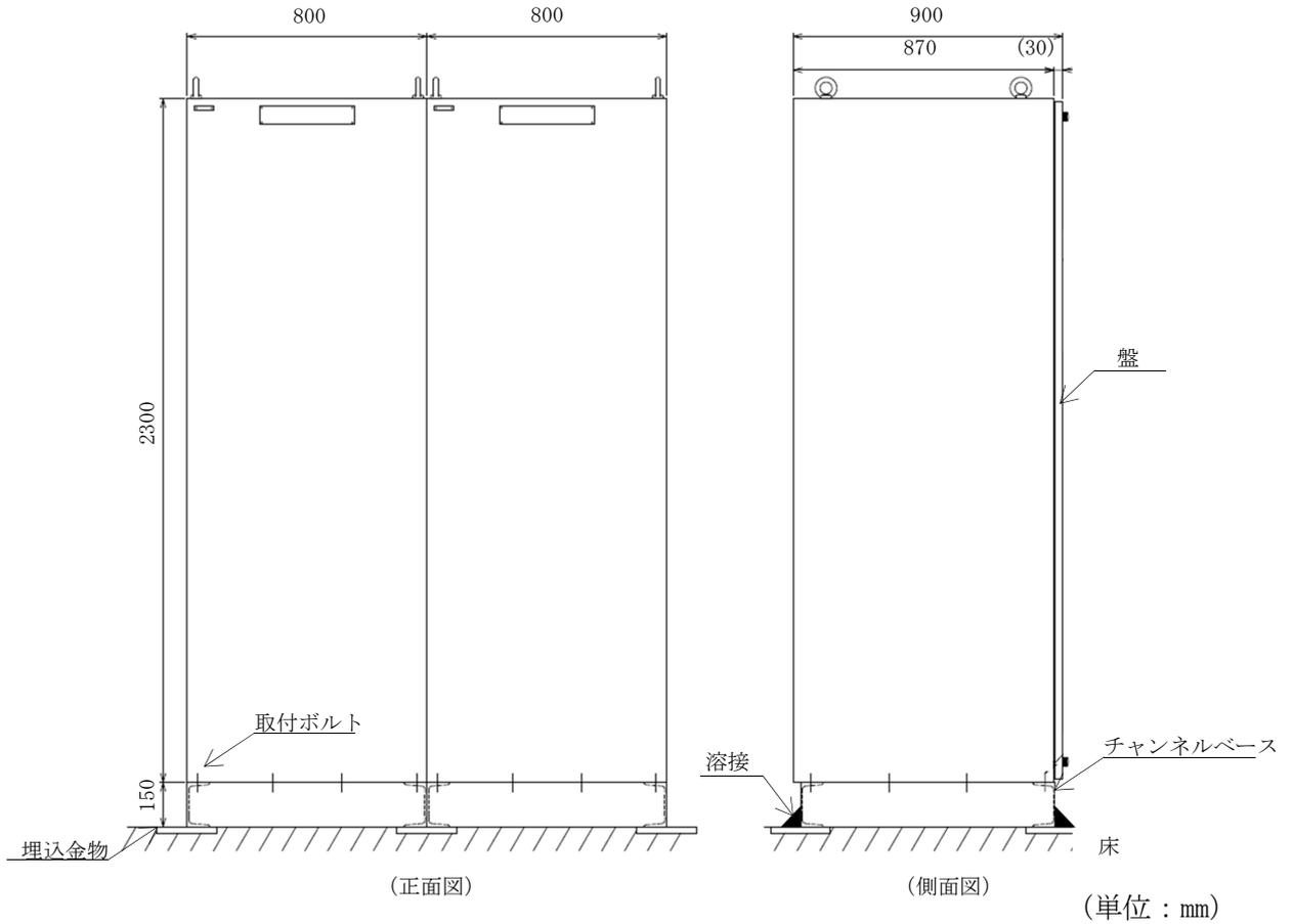
図 2-7 火災受信機盤①の概要図
