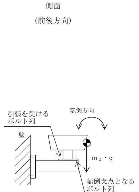
図5-5 火災感知器⑤の計算モデル
