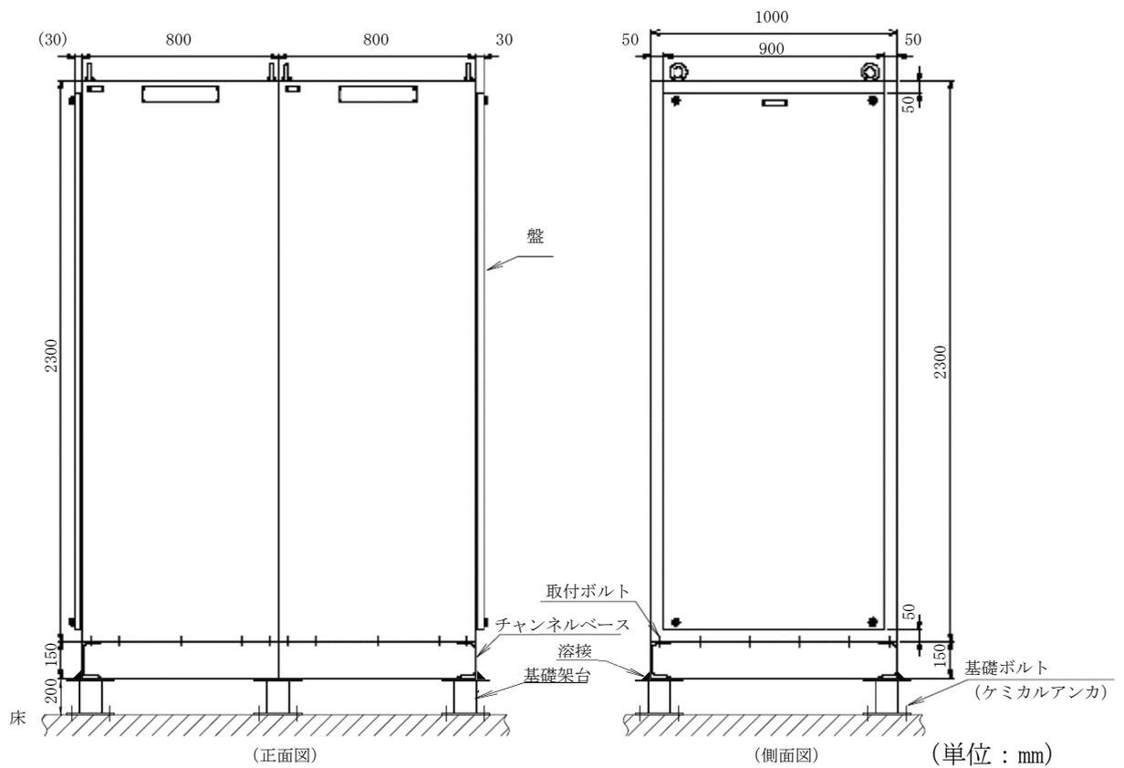
図 2-8 火災受信機盤②の概要図
