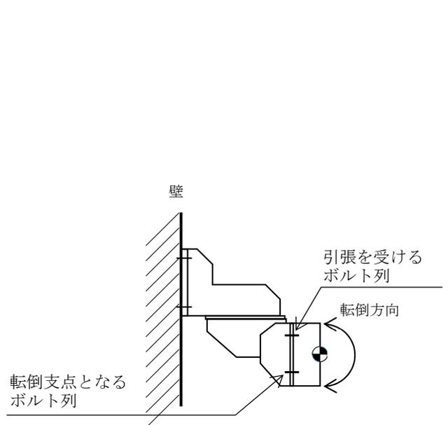
図 5-3 火災感知器③の計算モデル
