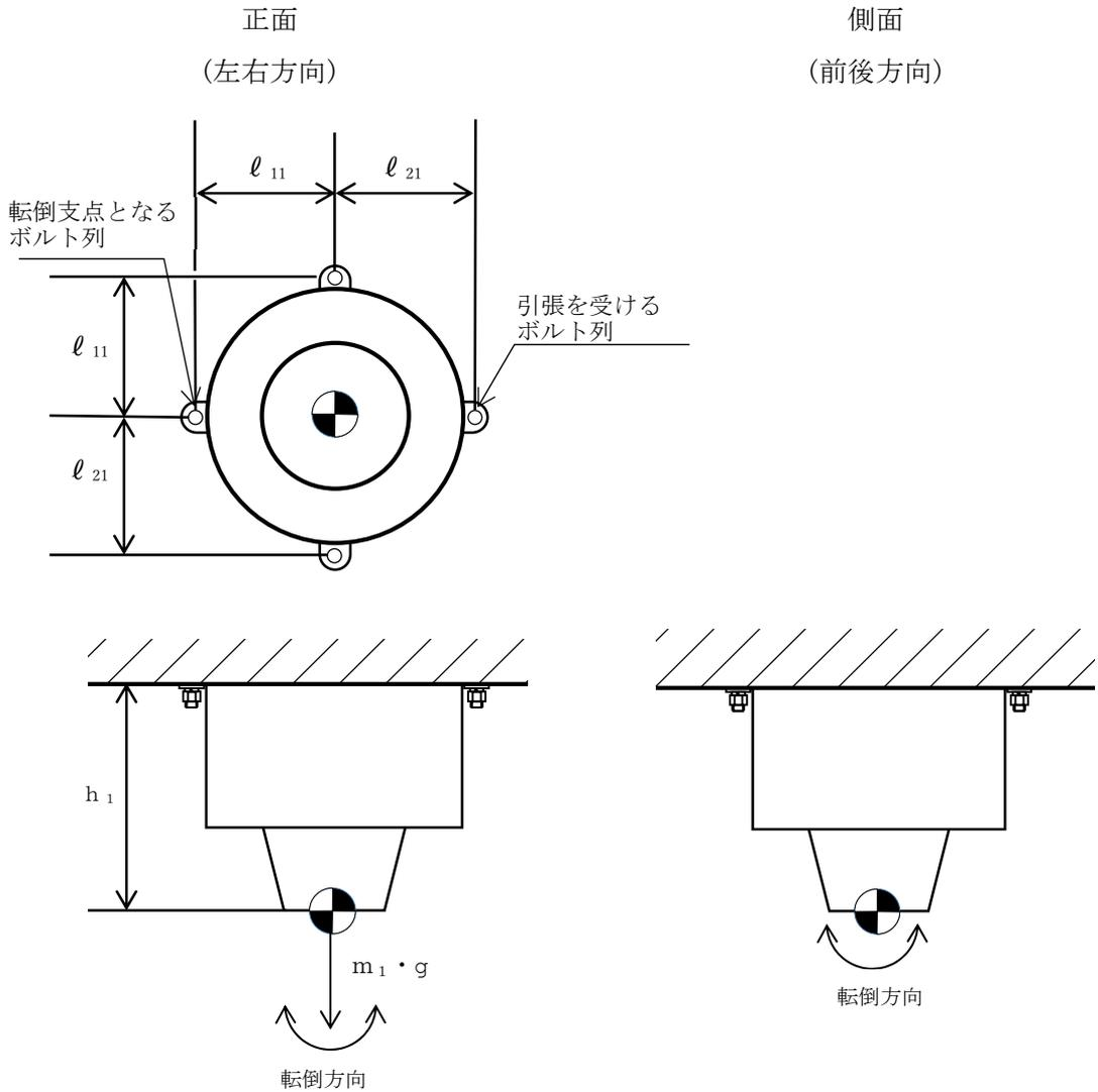
図5-2 火災感知器②の計算モデル
