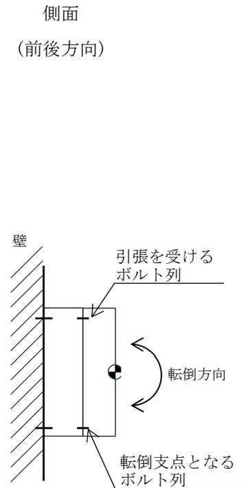
図5-4 火災感知器④の計算モデル
