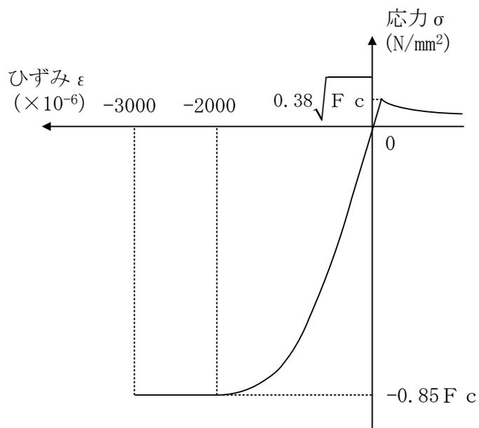
$F_c$  : コンクリートの設計基準強度
