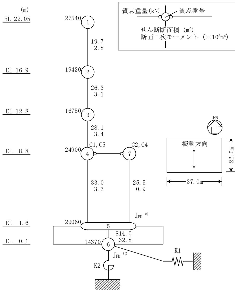
注記\*1：回転慣性重量（基礎スラブ上端）(47.46×10<sup>5</sup>kN・m<sup>2</sup>)
