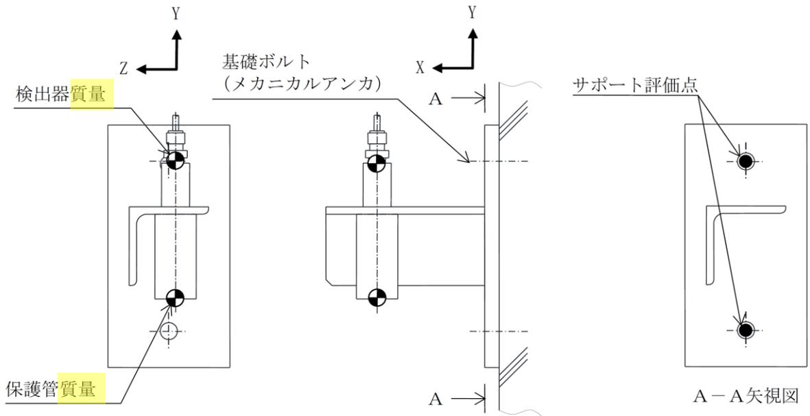
図 2-4 計算モデル (基礎ボルト) (LE2B5-6)
