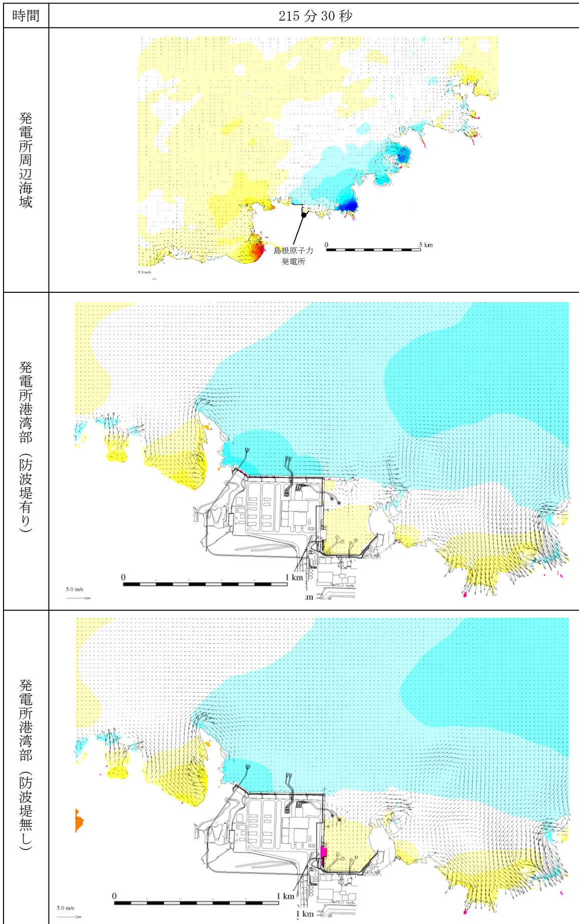
図 1-232 基準津波 1 の水位変動・流向ベクトル
