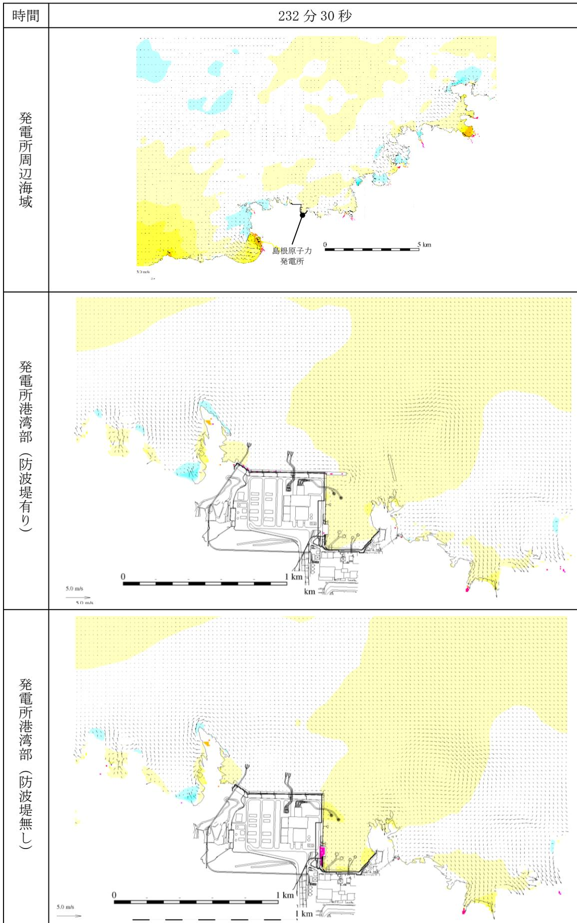
図 1-266 基準津波 1 の水位変動・流向ベクトル
