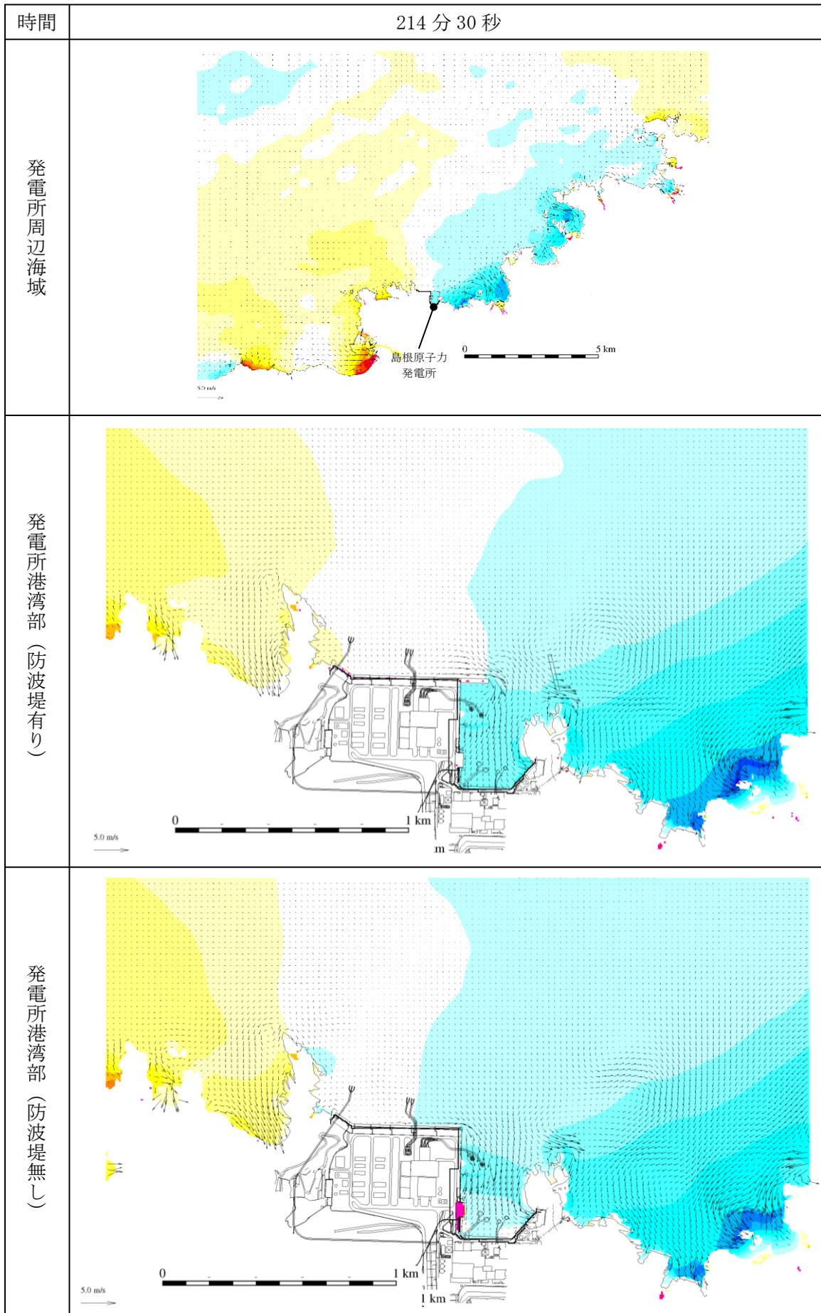
図 1-230 基準津波 1 の水位変動・流向ベクトル
