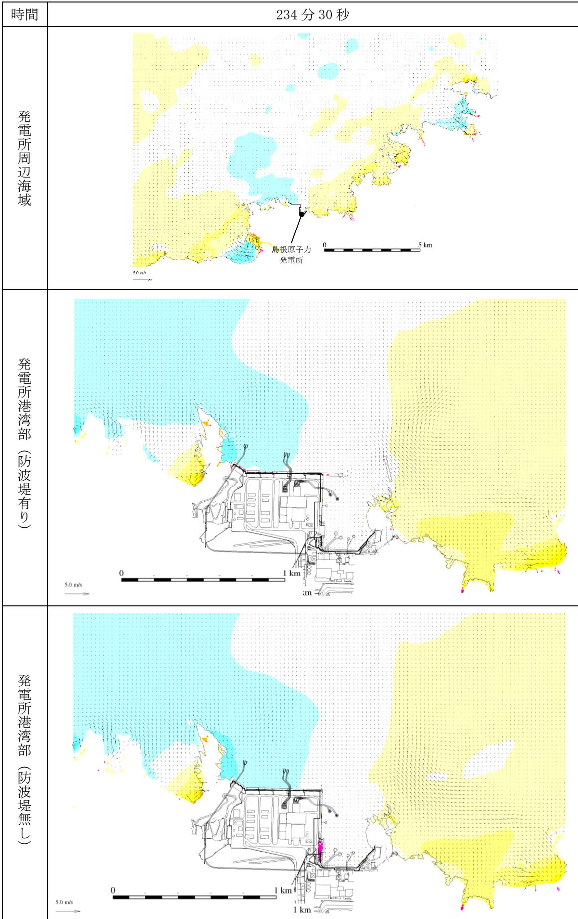
図 1-270 基準津波 1 の水位変動・流向ベクトル
