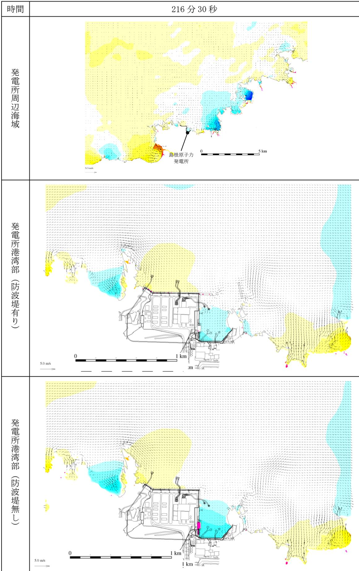
図 1-234 基準津波 1 の水位変動・流向ベクトル
