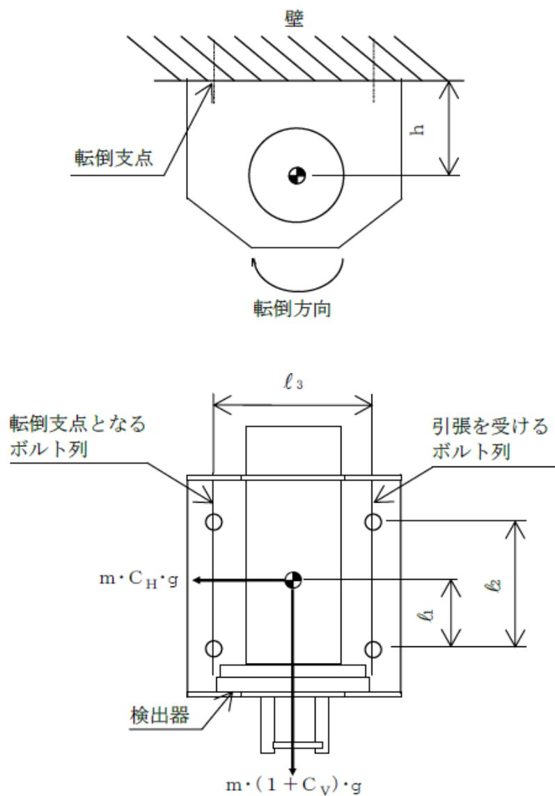
図5-1 計算モデル（壁掛形 左右方向転倒）
