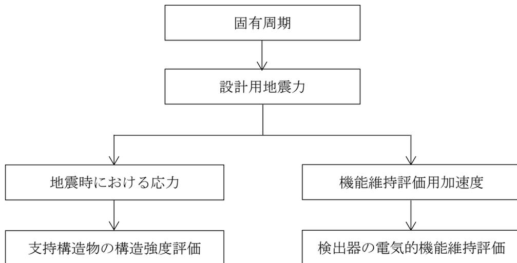
図2-1 燃料プールエリア放射線モニタ（低レンジ）（SA）の耐震評価フロー
