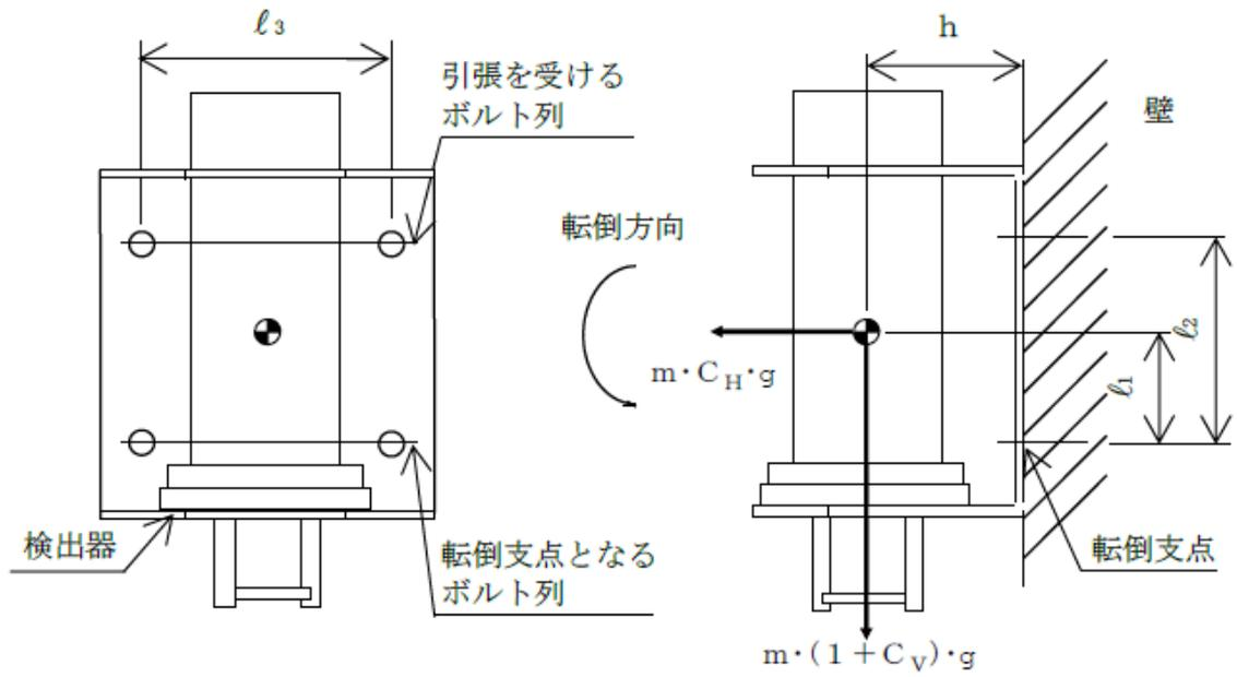
図5-2 計算モデル（壁掛形 前後方向転倒）
