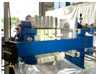
脱水処理(脱水物取出し工程)
