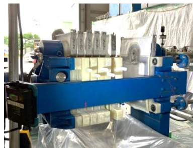
脱水処理(脱水物取出し工程)
