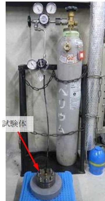
図5 He気密確認試験状況
