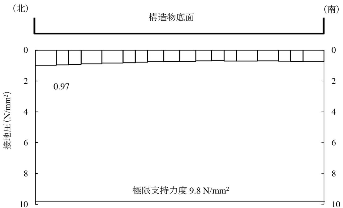
図 4-3 基礎地盤の最大接地圧分布図
