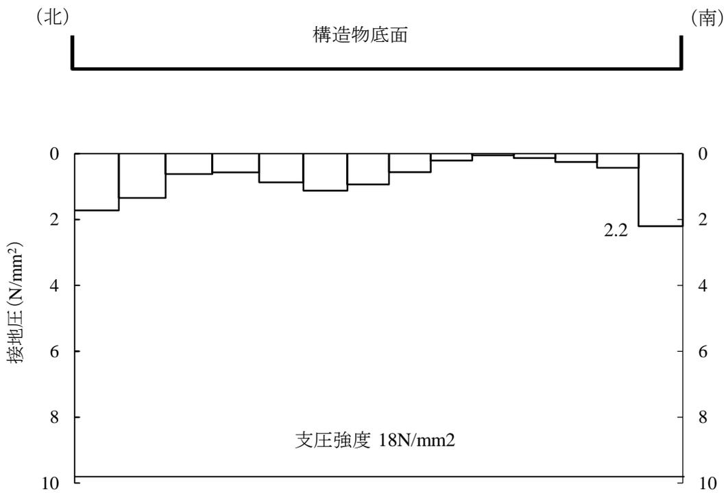
図 4-4 MMR の最大接地圧分布図
