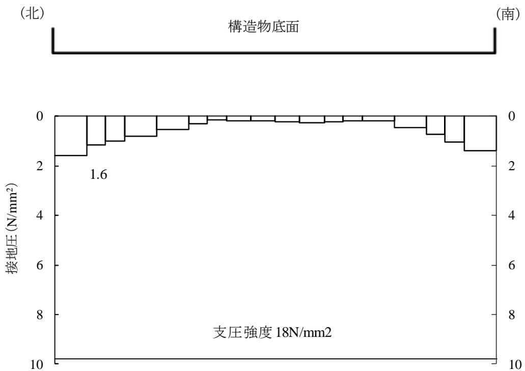
図 4-5 MMR の最大接地圧分布図
