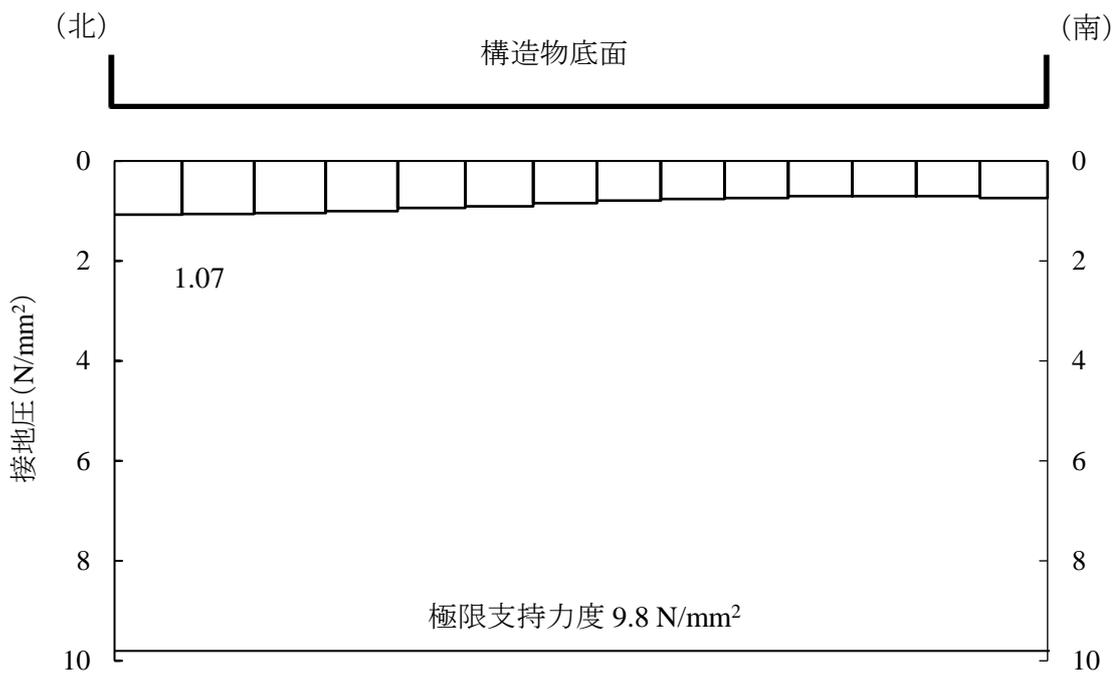
図 4-2 基礎地盤の最大接地圧分布図
