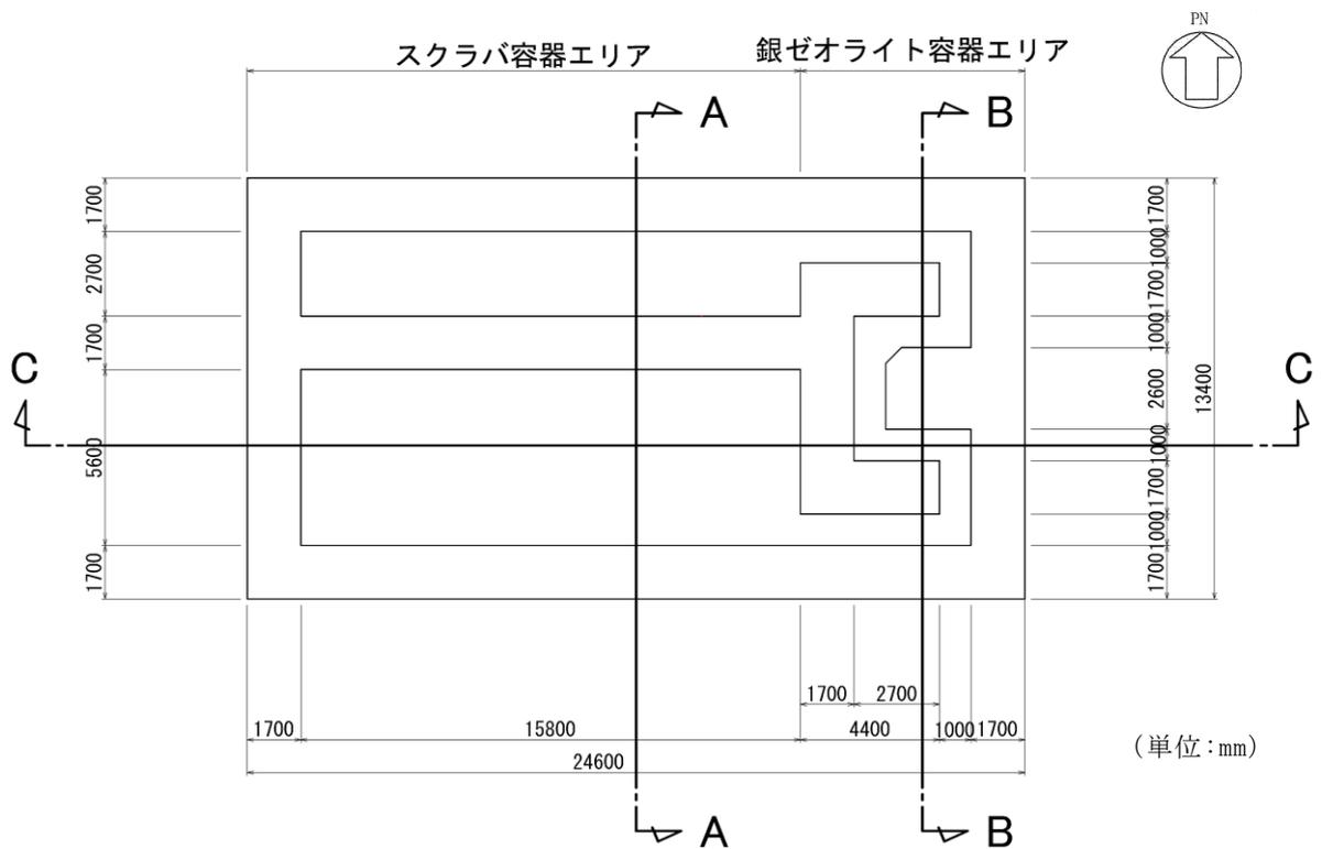
図2-2 第1ベントフィルタ格納槽 平面図
