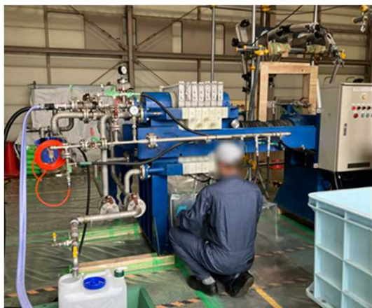
脱水処理(圧搾工程)
