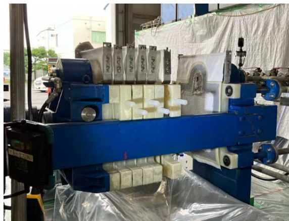
脱水処理(脱水物取出し工程)
