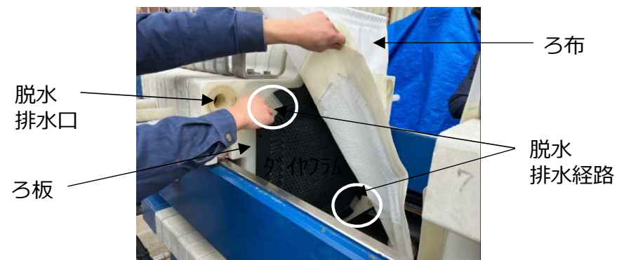
視点②：ろ布取付治具部 拡大写真
