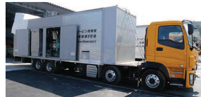
発電機車 出力3,600kW×2台
