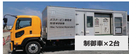
発電機車 出力3,600kW×2台
