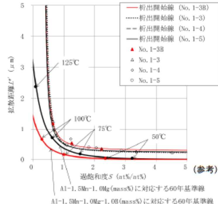
※2)9章にて後述するように、許容応力の設定に使用した材料はMg添加量を約1.0 mass%に調整しているため、当該許容応力は、60年後においても維持できる固溶強化に基づいた設定と整理される。
