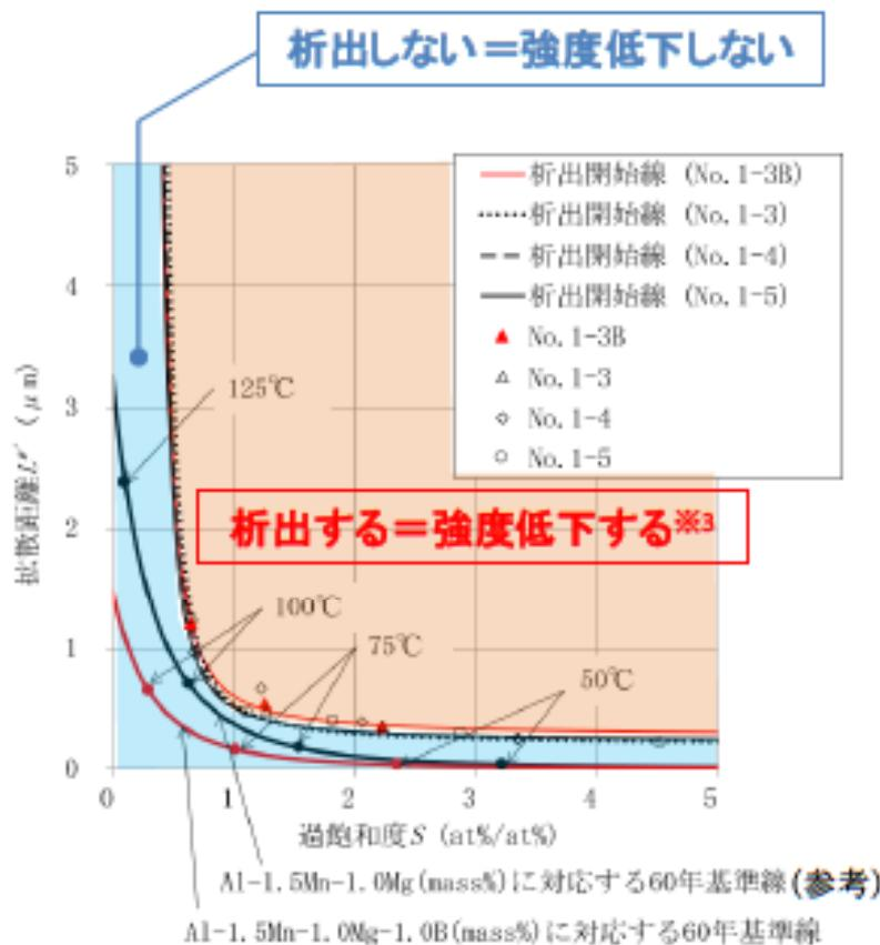
※3) SLP線図における60年基準線を用いた析出評価は一定温度を前提としているため、徐々に温度低下する実機条件に対して安全側の評価となる。このため仮に原点と反対側の領域でも、実機では析出しない(强度低下しない)状況は十分に生じうる。
