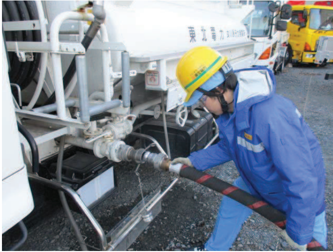
タンクローリへのホース接続
