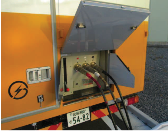
電源車ケーブル接続
