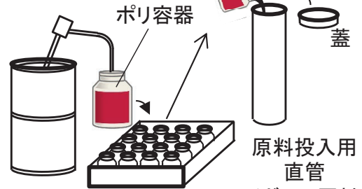
模擬廃液入りドラム缶 原料投入用直管(ガラス原料10個収納)
