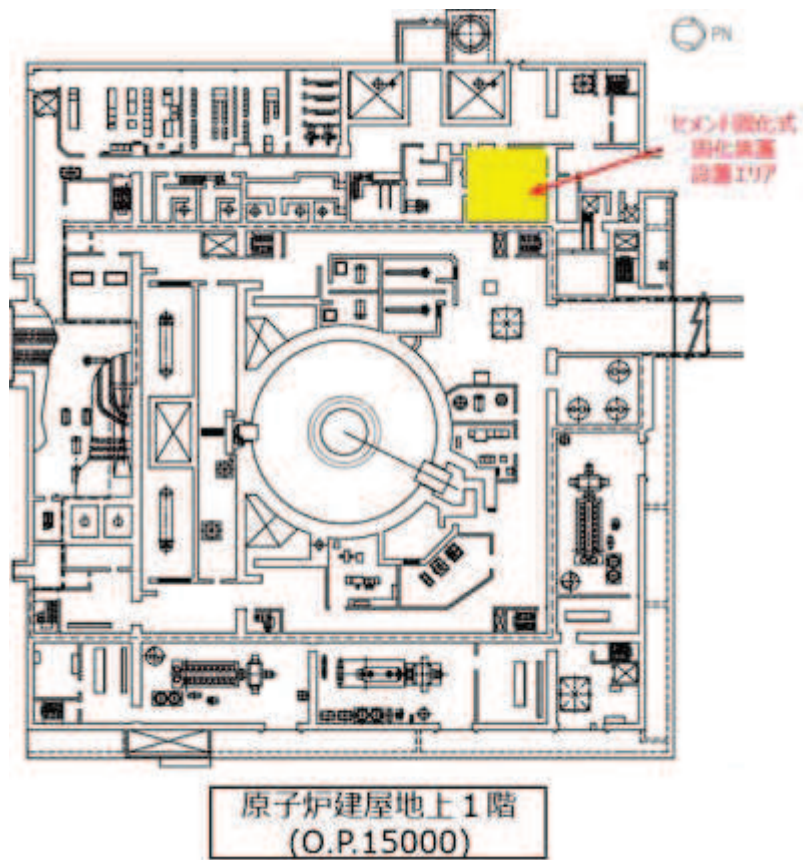
第4-1図 セメント固化式固化装置の設置場所
