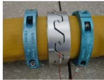
可搬型ホース（150A）接続後
