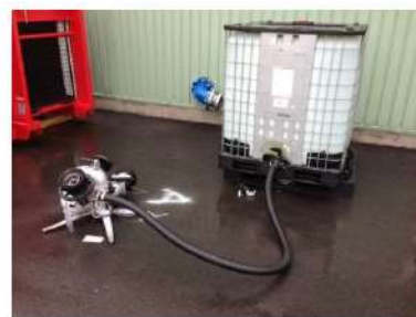
小型放水砲及び泡消火薬剤
