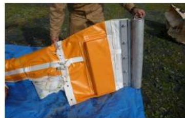
荷揚場シルトフェンス端部
