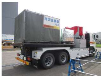
泡混合設備運搬
