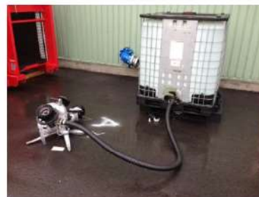
小型放水砲及び泡消火薬剤
