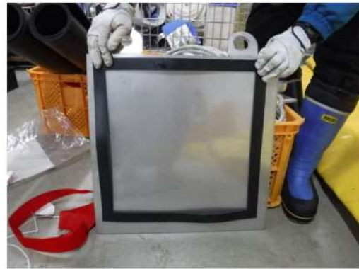
ガスケット材取付けイメージ
