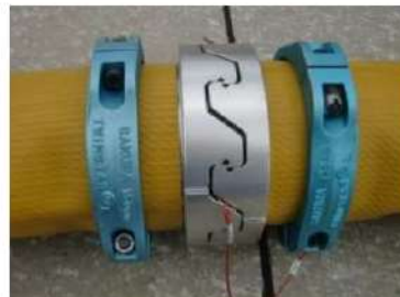
可搬型ホース(150A)接続後
