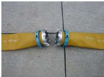
可搬型ホース (150A) 接続前
