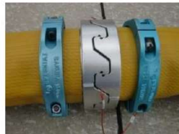
可搬型ホース(150A) 接続後
