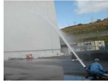
可搬型スプレイノズルによる スプレイ状況 (屋外での模擬訓練)
