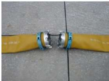
可搬型ホース(150A)接続前
