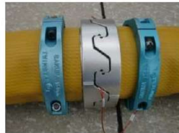
可搬型ホース(150A)接続後
