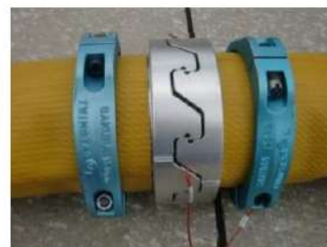
可搬型ホース(150A)接続後
