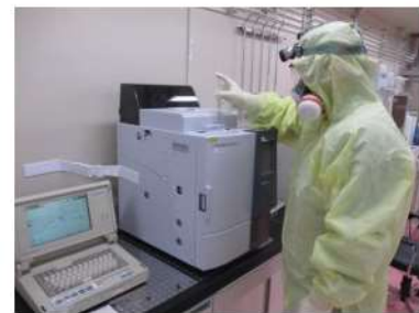
ガス分析計による水素濃度測定 (原子炉補助建屋 T. P. 2.8m (中間床))
