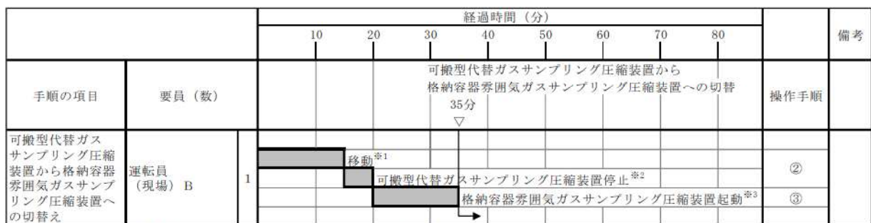
第 1.9.8 図 可搬型格納容器内水素濃度計測ユニットによる原子炉格納容器内の水素濃度監視 タイムチャート
