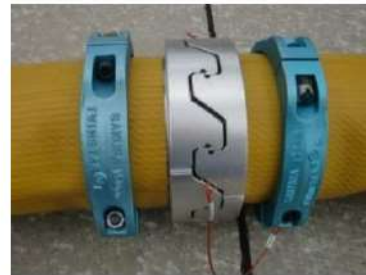
可搬型ホース（150A）接続後
