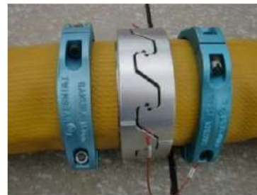
可搬型ホース(150A)接続後
