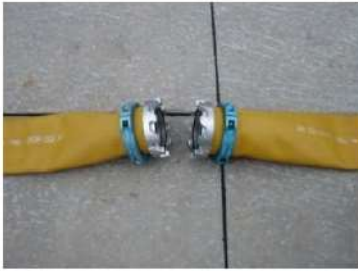
可搬型ホース（150A）接続前
