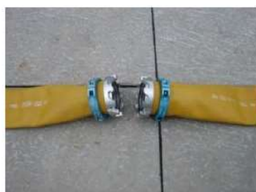
可搬型ホース(150A)接続前
