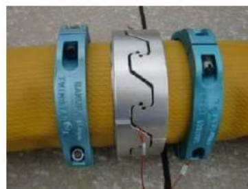
可搬型ホース(150A)接続後
