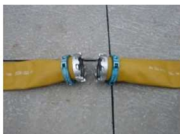
可搬型ホース(150A)接続前
