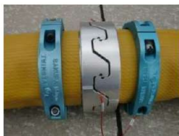
可搬型ホース(150A)接続後
