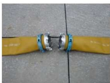
可搬型ホース(150A)接続前
