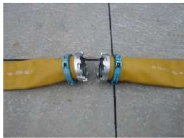
可搬型ホース（150A）接続前
