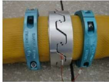
可搬型ホース（150A）接続後
