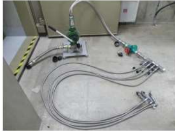
専用工具（タービン動補助給水ポンプ潤滑油供給器） （タービン動補助給水ポンプ室に保管）
