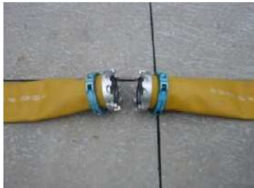
可搬型ホース (150A) 接続前
