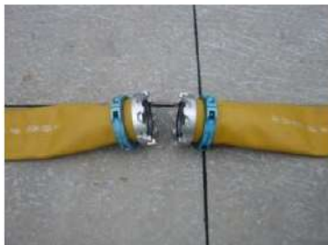
可搬型ホース(150A)接続前
