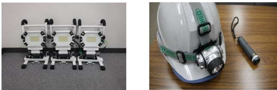
図 18 可搬型照明（SA）、可搬型照明（ヘッドライト）等
