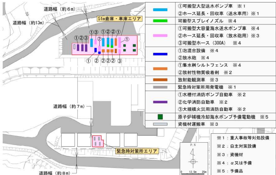
第2図 保管場所の可搬型設備配置(1/3)
