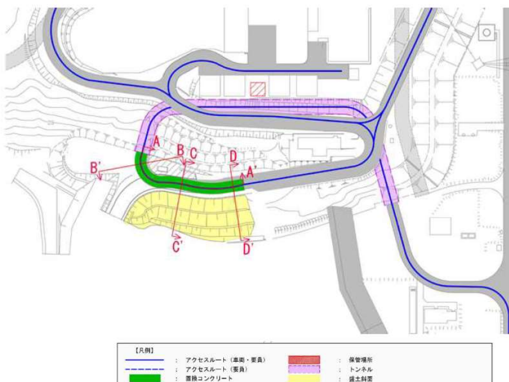
第 8.2-1 図 置換コンクリート範囲図
