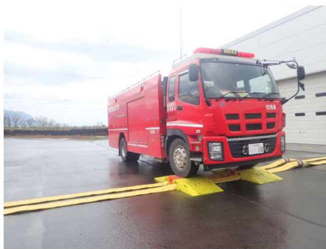
第1図 ホースブリッジの設置状況
