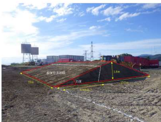
第3図 斜面崩壊後を模擬した土砂
