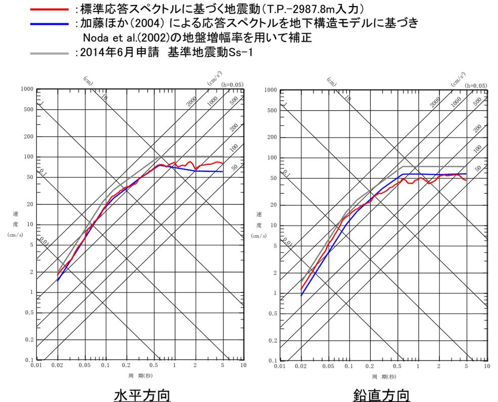
東通原子力発電所の解放基盤表面の振動特性を代表する位置における応答スペクトルの比較
