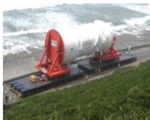
原子炉圧力容器の 陸上輸送の様子
