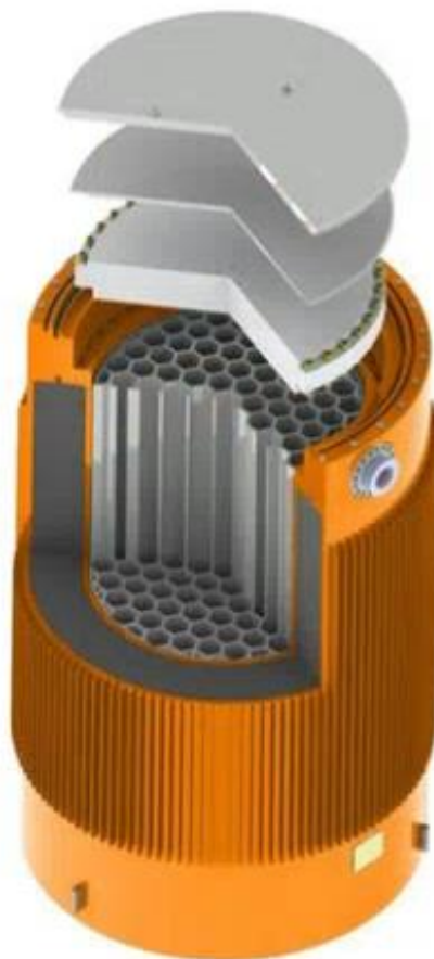
図 2.1-6 CONSTOR キャスクの構造[BGR3]
