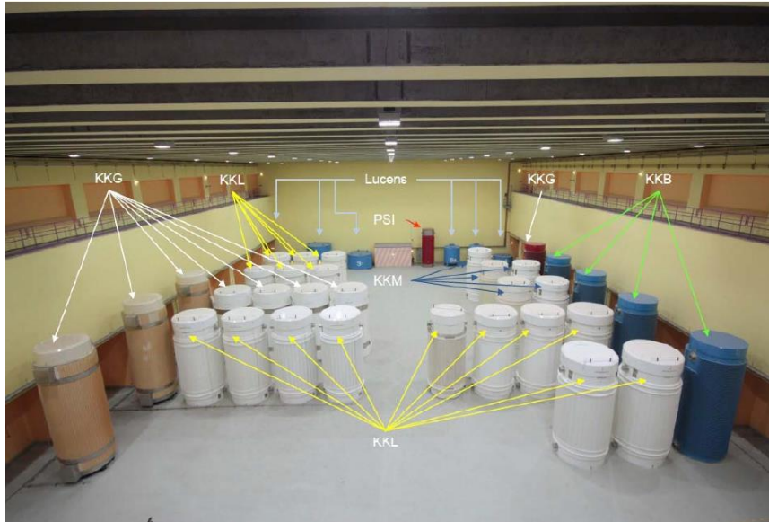
図 2.1-37 ヴュレンリンゲン集中中間貯蔵施設(ZLL)のキャスク貯蔵状態[CHE14]
