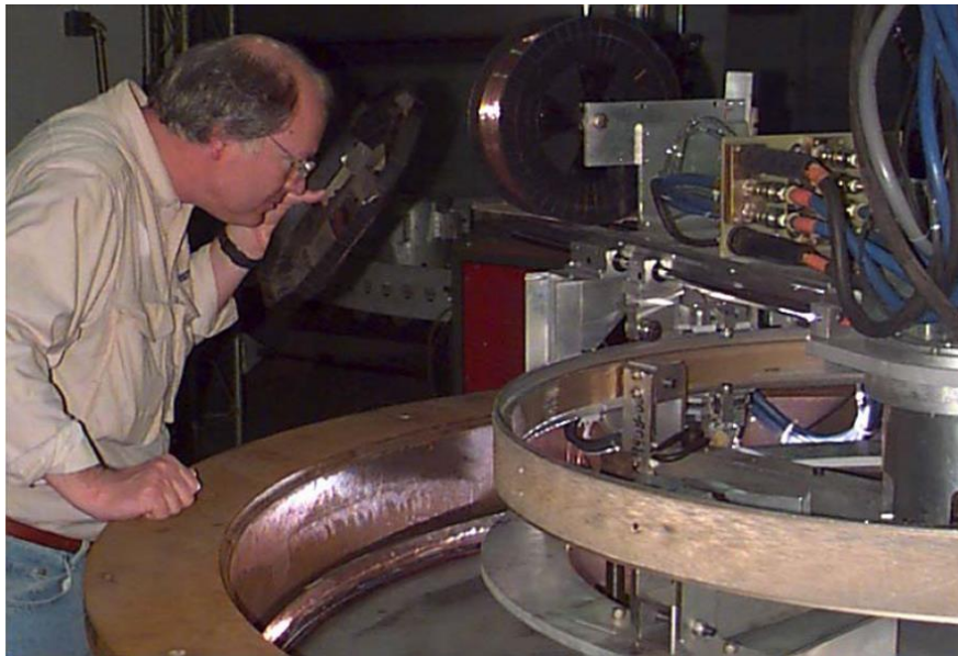
図 2.2-3 半自動回転遠隔溶接システム
