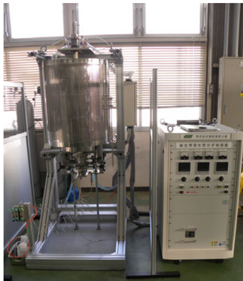
図 1 セル内小型燃料加熱装置の外観 (左側がセル内に設置する装置本体、右側はセル外に設置する制御盤)
