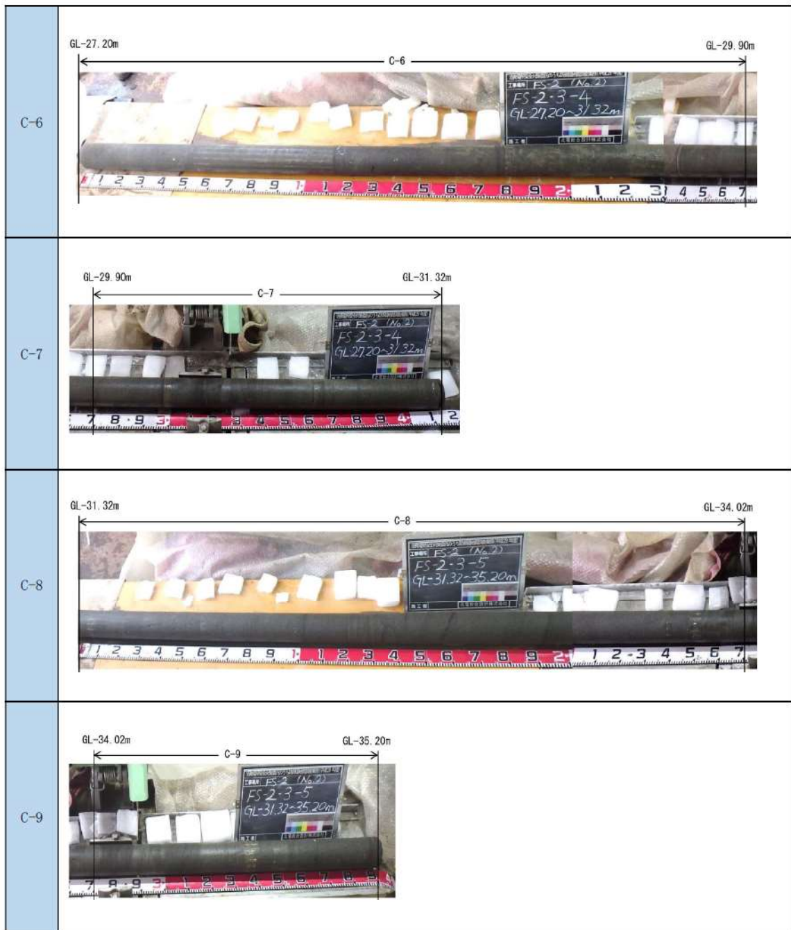
添付 1-55 図(8/10) ボーリング柱状図・コア写真 (FS-2)
