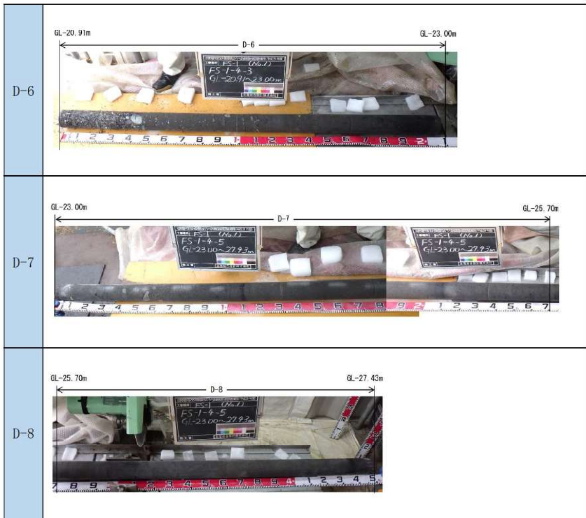
添付 1-54 図(10/10) ボーリング柱状図・コア写真 (FS-1)
