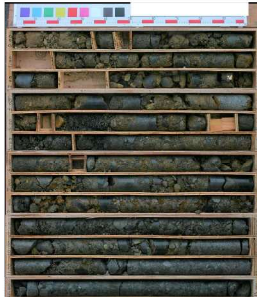
添付 1-17 図 ボーリング柱状図・コア写真 (H19-1)
