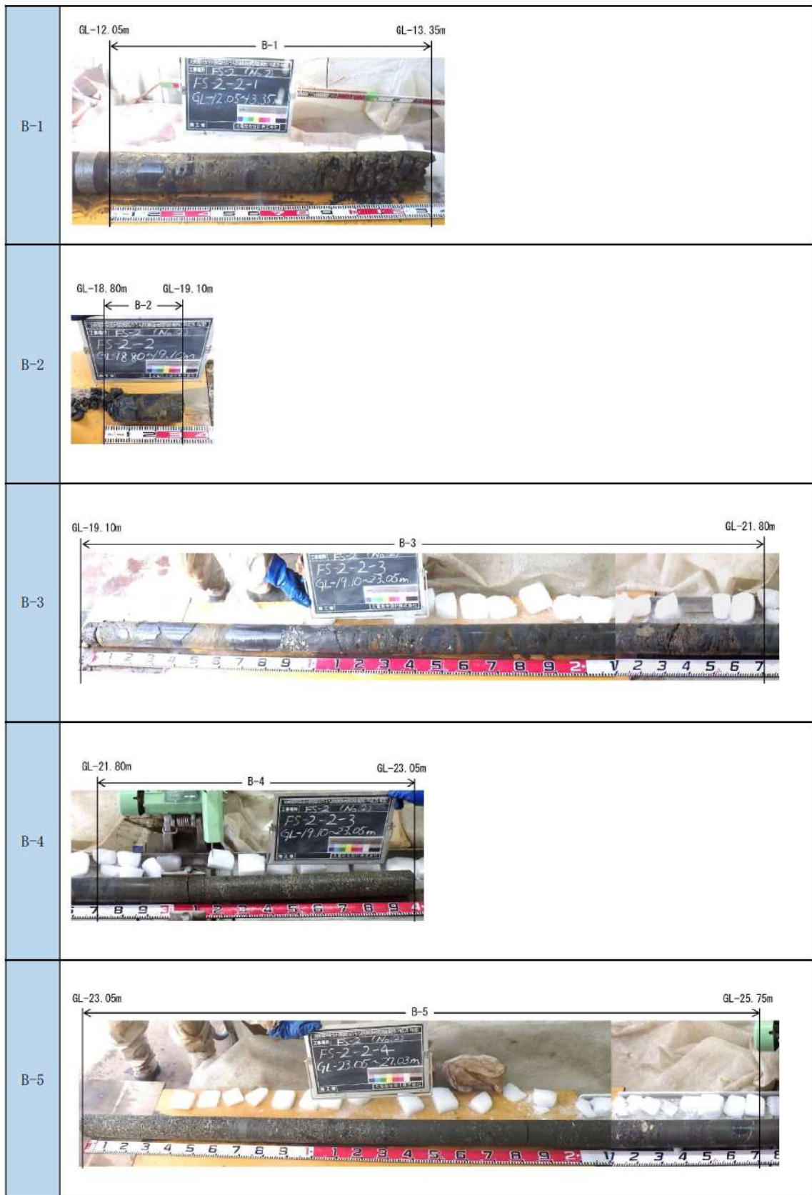
添付 1-40 図(5/10) ボーリング柱状図・コア写真 (FS-2)
