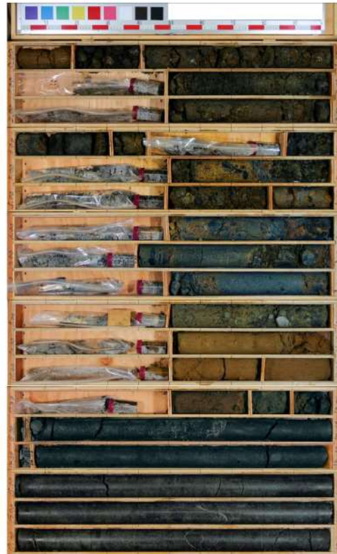
添付 1-15 図 ボーリング柱状図・コア写真 (U-7)
