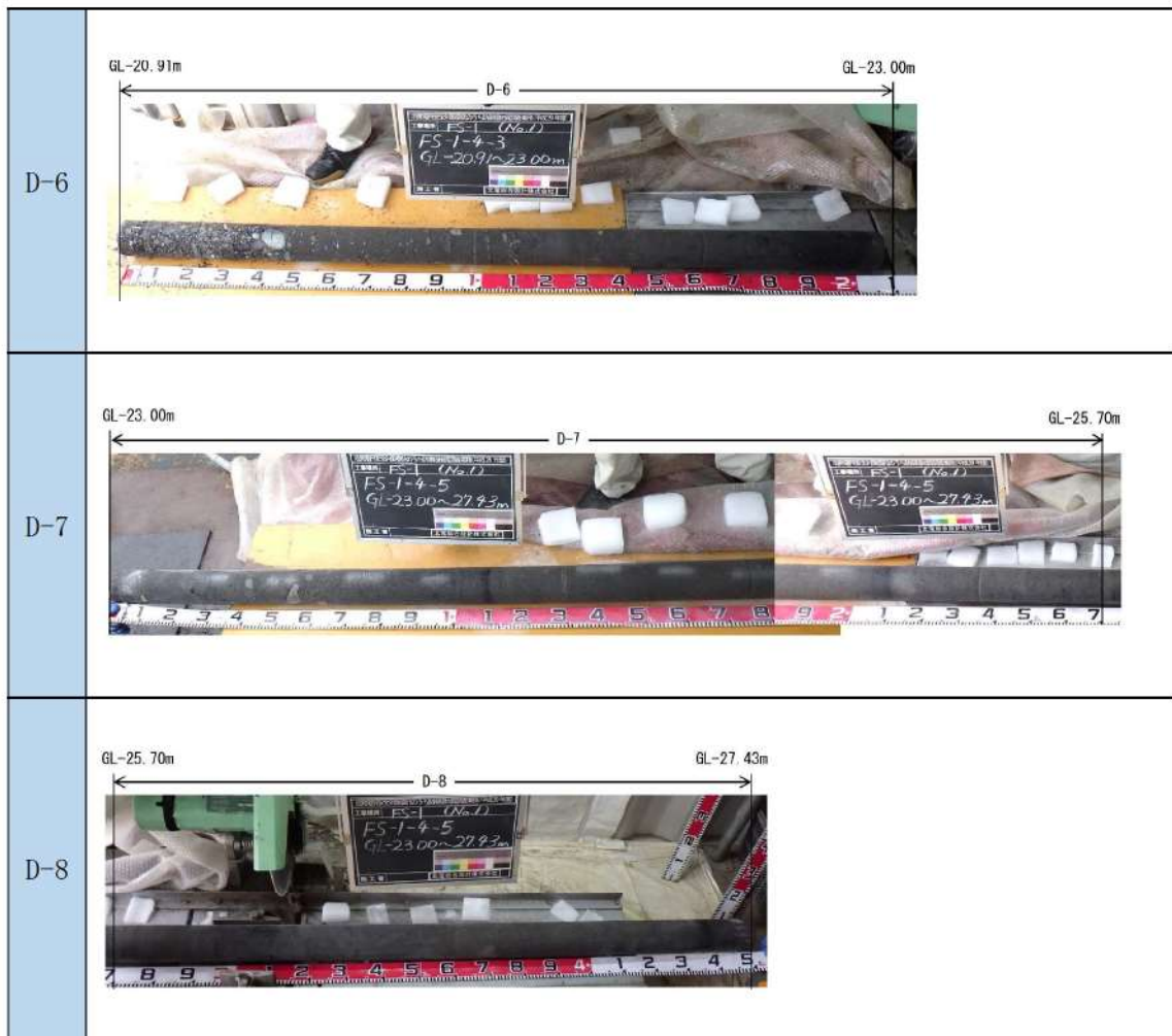
添付 1-39 図(10/10) ボーリング柱状図・コア写真 (FS-1)
