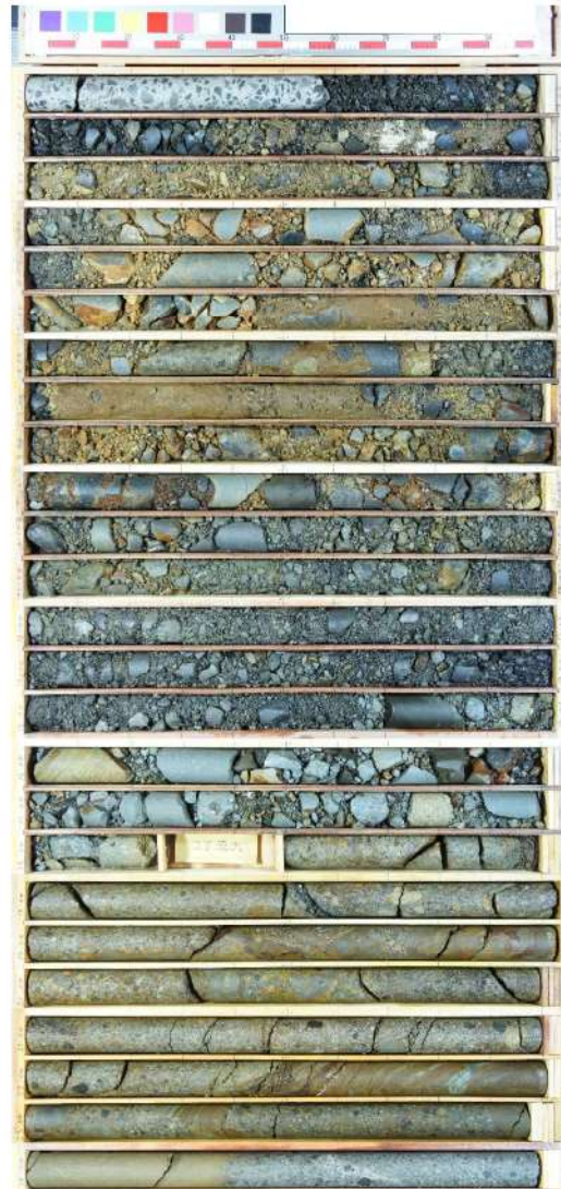
添付 1-21 図 (1/2) ボーリング柱状図・コア写真 (RE-9)
