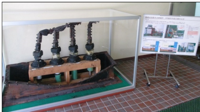
柏崎刈羽3号炉 所内変圧器の火災
