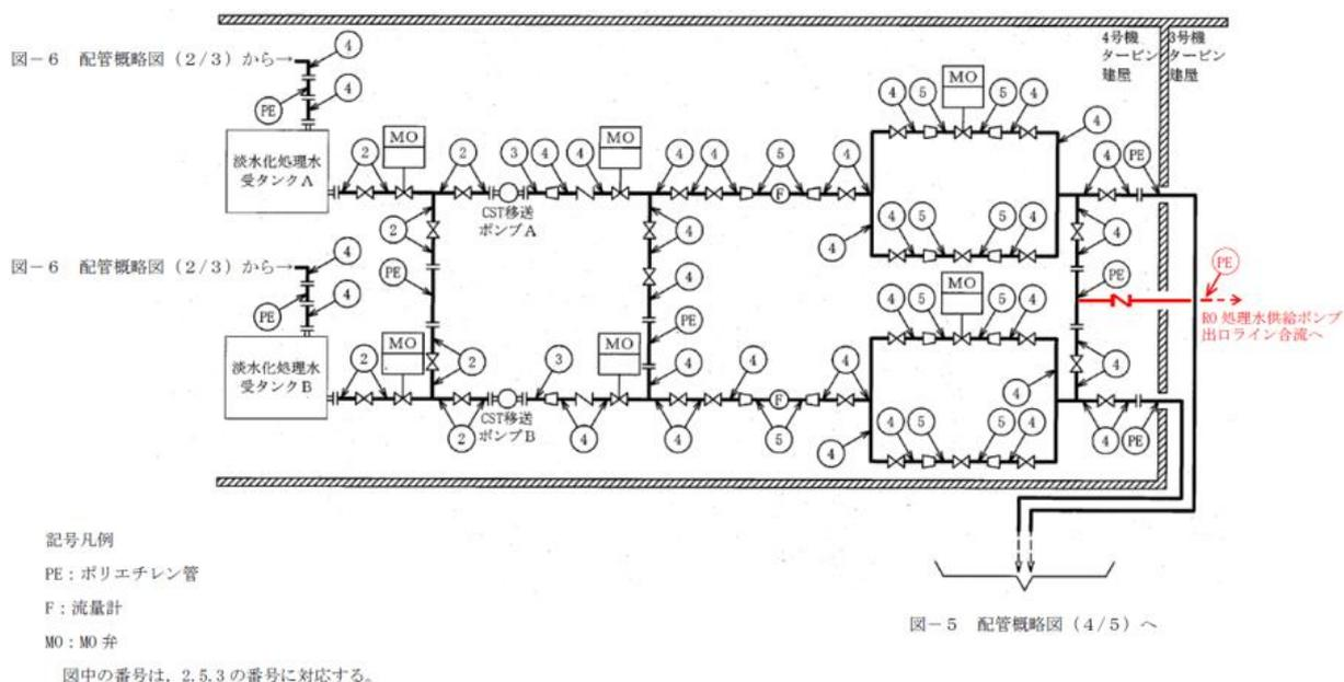
図 2.14.1-2 配管概略図 (建屋内RO 附属配管を除く主配管)
