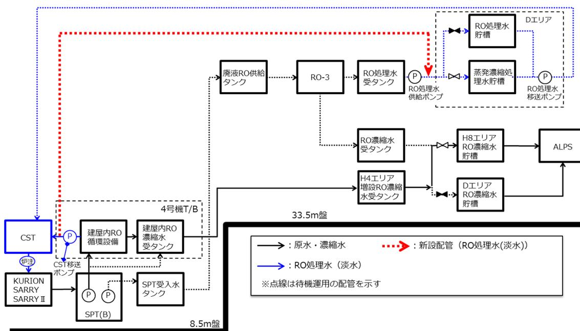
図 1.1-1 建屋内RO処理水移送配管の追設（その1）
