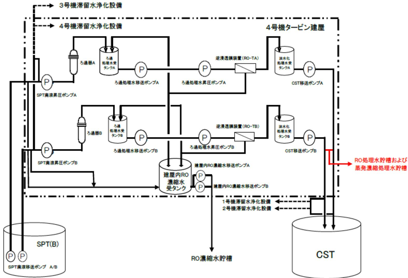
図2.14.1-1 淡水化装置（逆浸透膜装置，蒸発濃縮装置）及び滞留水浄化設備の系統構成図（2/2）
