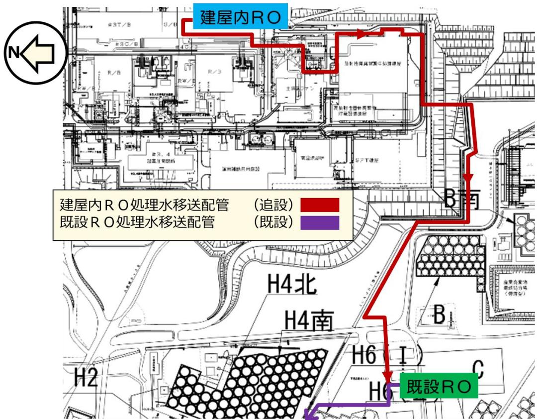
図 1.1-2 建屋内RO処理水移送配管の追設 (その2)
