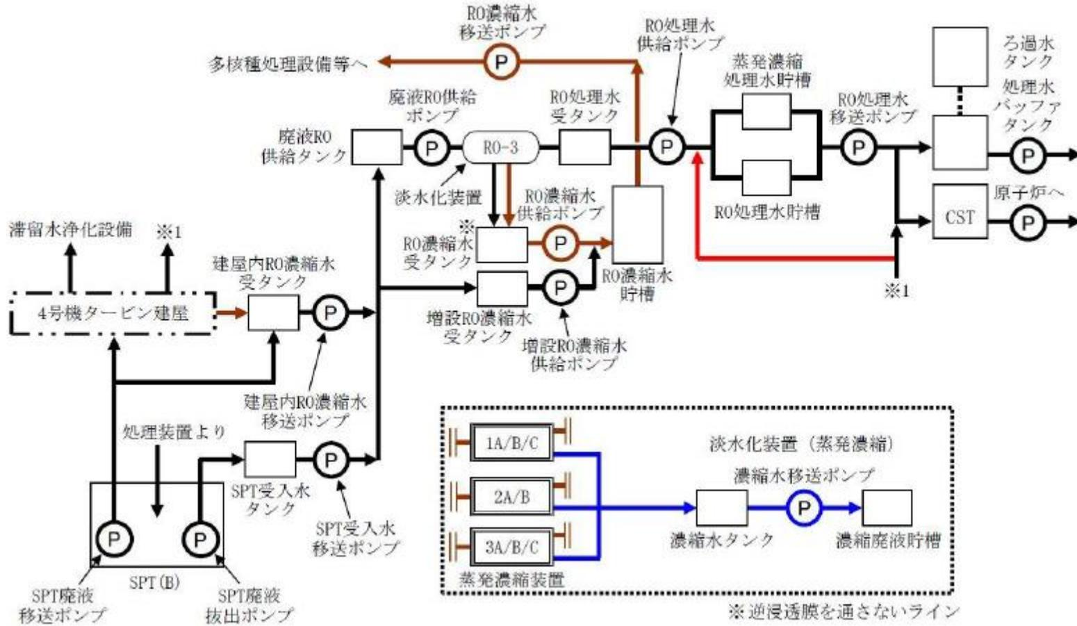
図2.14.1-1 淡水化装置（逆浸透膜装置，蒸発濃縮装置）及び滞留水浄化設備の系統構成図（1/2）
