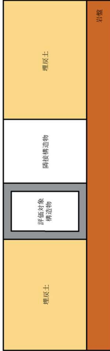
隣接構造物のモデル化例（評価対象構造物と隣接構造物が接している場合）
